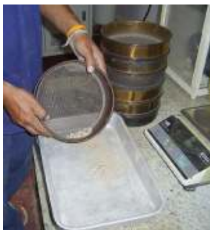
รูปที่ 1.3 แยกตัวอย่างที่ค้างบนแต่ละตะแกรง ออกจากตะแกรง
