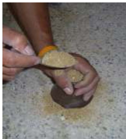
รูปที่ 2 แบ่งตัวอย่างทรายด้วยเครื่องแบ่งตัวอย่าง รูปที่ 3 ใส่ตัวอย่างทรายลงในกรวย
