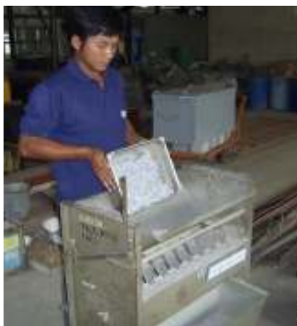
รูปที่ 1 สุ่มตัวอย่างด้วยเครื่องแบ่งตัวอย่าง
