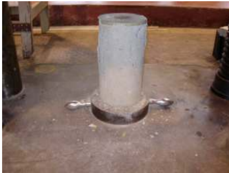
รูปที่ 7 แท่งตัวอย่างรูปทรงกระบอกที่ทดสอบบีบอัด
