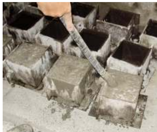
รูปที่ 2 การหล่อแท่งคอนกรีตโดยใช้เครื่องสั่นคอนกรีตชนิดจุ่ม
