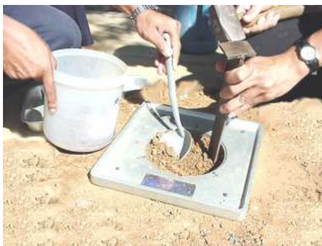
รูปที่ 2 การทดสอบความแน่นในสนาม
