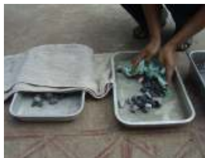
รูปที่ 2 เช็ดตัวอย่างที่แช่น้ำไว้ให้มีสภาพ อิมตัวผิวแห้ง
