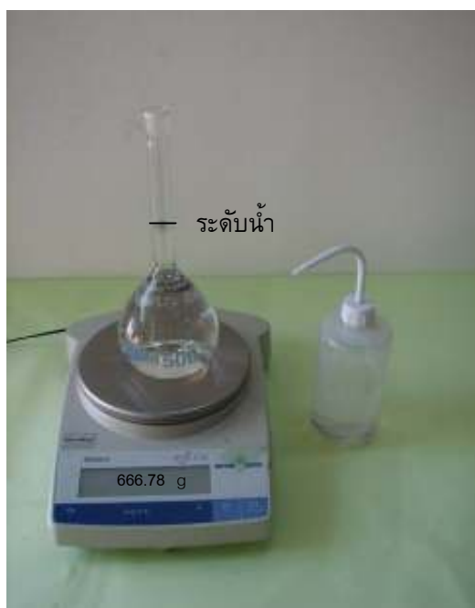
รูปผนวกที่ 1 ชั่งน้ำหนักขวด Pycnometer และน้ำ
