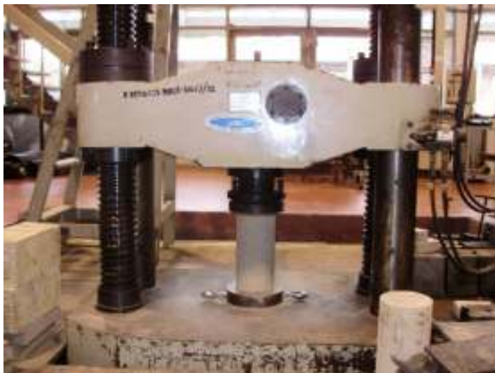
รูปที่ 4 การนำแท่งตัวอย่างวางบนกึ่งกลางของแท่นทดสอบ
