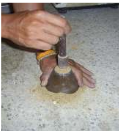
รูปที่ 4 ใช้แท่งตำโลหะตบกระแทกตัวอย่าง จำนวน 25 ครั้ง
