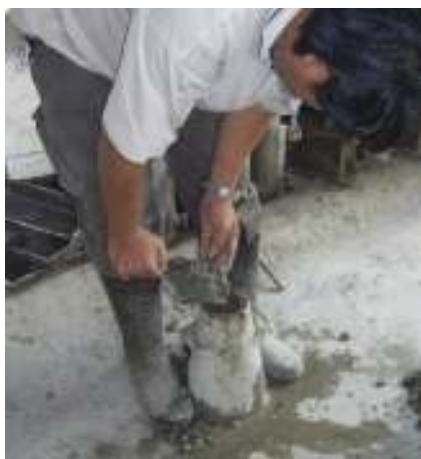
รูปที่ 2 ตักคอนกรีตใส่กรวย 1/3 ของปริมาตร
