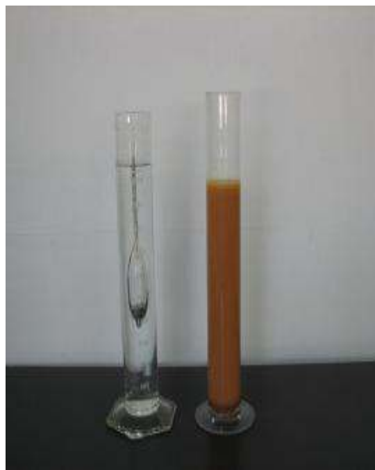
รูปที่ 4 การเก็บไฮโดรมิเตอร์ในขณะรอเวลาทดสอบ
