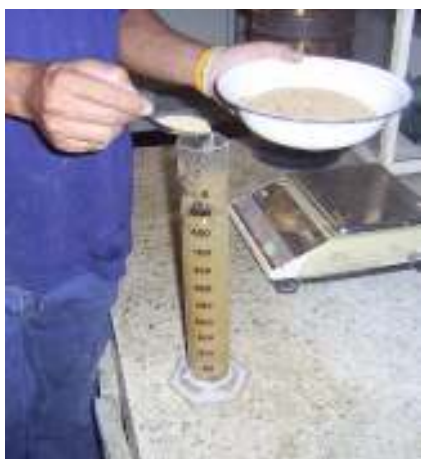
รูปที่ 6 ใส่ตัวอย่างทรายลงในกระบอกตวง เติมน้ำ และไล่ฟองอากาศออก
