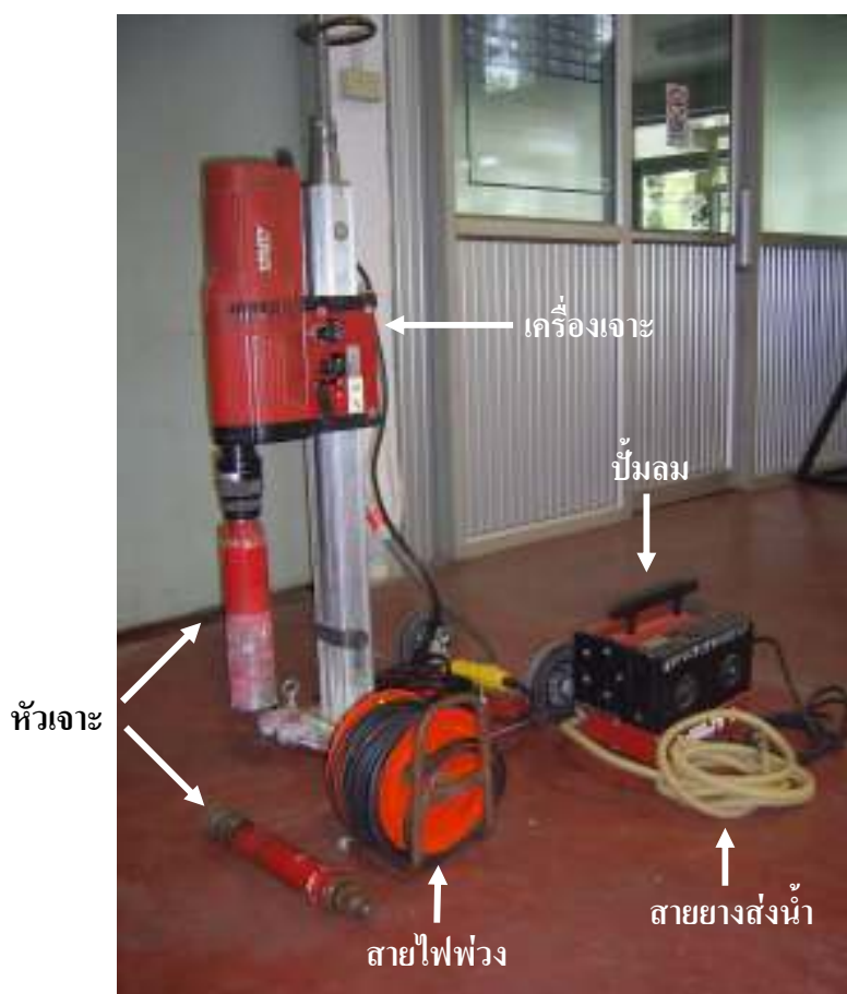
รูปที่ 1 เครื่องเจาะแท่งคอนกรีตพร้อมหัวเจาะ
