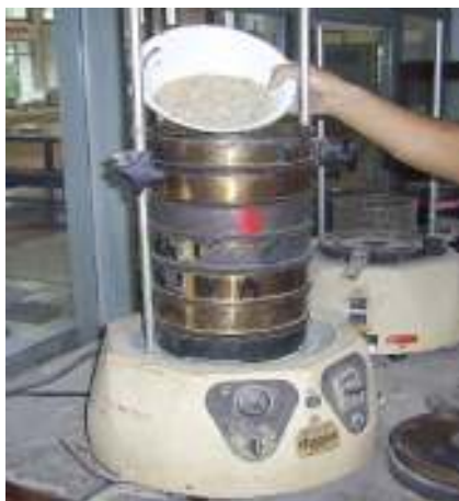
รูป 1.1 ติดตั้งตะแกรงกับเครื่องเขย่า ใส่ ตัวอย่างที่เตรียมไว้ลงไป
