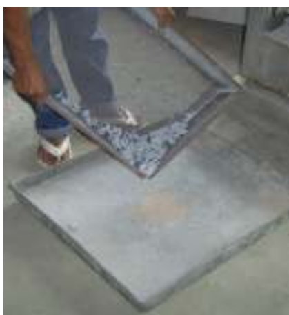
รูปที่ 2.3 แยกตัวอย่างที่ค้างแต่ละตะแกรง ออกจากตะแกรง
