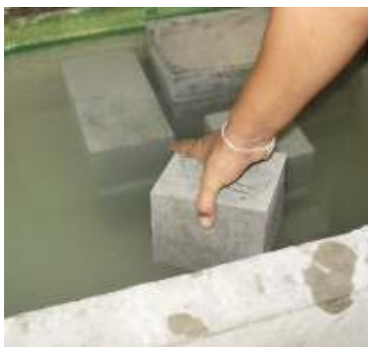
รูปที่ 3 การบ่มแท่งตัวอย่างด้วยน้ำ
