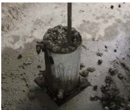
รูปที่ 1 การหล่อแท่งคอนกรีตโดยใช้เหล็กกระทุ้ง
