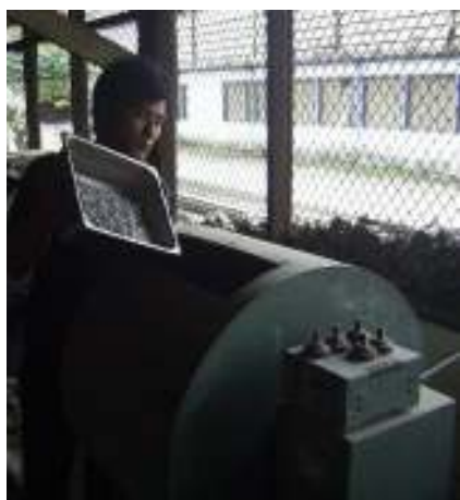
รูปที่ 3 ใส่ตัวอย่างและลูกเหล็กลงในเครื่องทดสอบ
