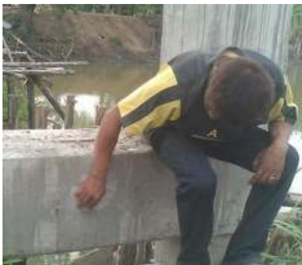
รูปที่ 2 ขัดทำความสะอาดด้วยหินขัดบริเวณพื้นผิวทดสอบให้เรียบ
