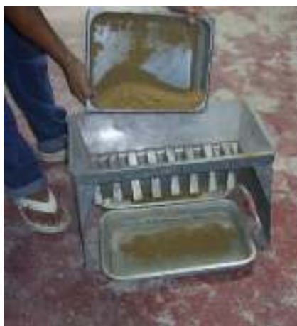
รูปที่ 2 แบ่งตัวอย่างทรายด้วยเครื่องแบ่งตัวอย่าง รูปที่ 3 ใส่ตัวอย่างทรายลงในกรวย
