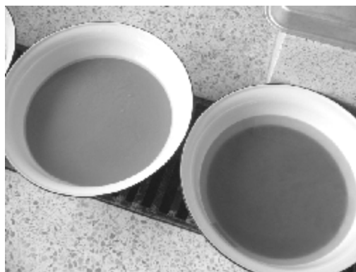
รูปที่ 5 ตัวอย่างส่วนที่ผ่านตะแกรงเบอร์ 200 สำหรับการทดสอบขนาดผลโดยไฮโดรมิเตอร์
