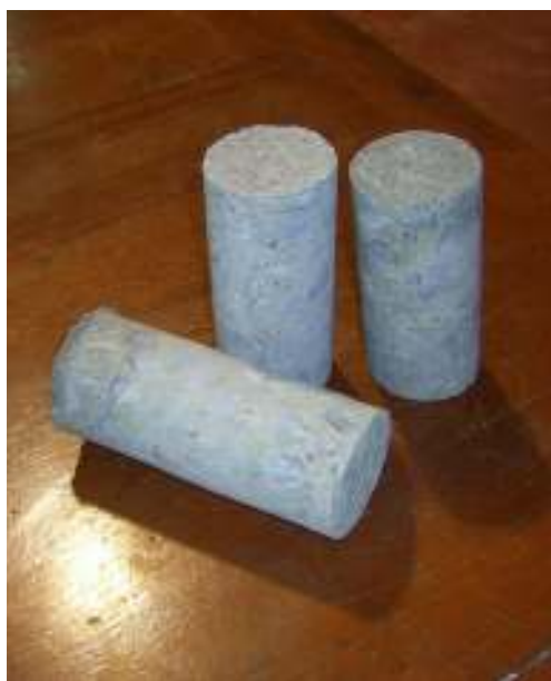
รูปที่ 2 ลักษณะตัวอย่างแท่งคอนกรีตที่เจาะจากโครงสร้าง
