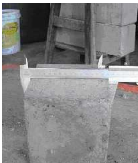
รูปที่ 1 วัดขนาดแท่งตัวอย่างรูปทรง ลูกบาศก์
