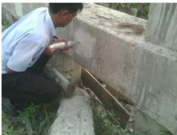
รูปที่ 3 กัดเกณฑ์ทดสอบตรงจุดที่จะทำการทดสอบในแนวตั้งฉากจนกระทั่งเกิดการสะท้อนกลับ
