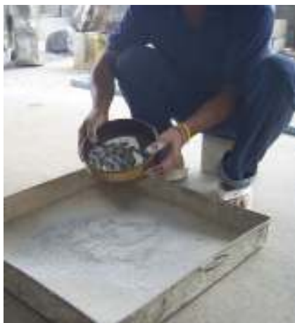
รูปที่ 5 ร่อนตัวอย่างด้วยตะแกรงเบอร์ 12
