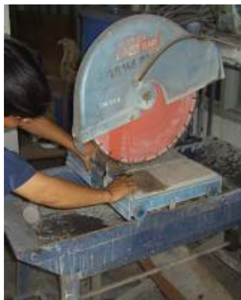
รูปที่ 3 ตัดตัวอย่างตัวเลื่อยตัดคอนกรีต
