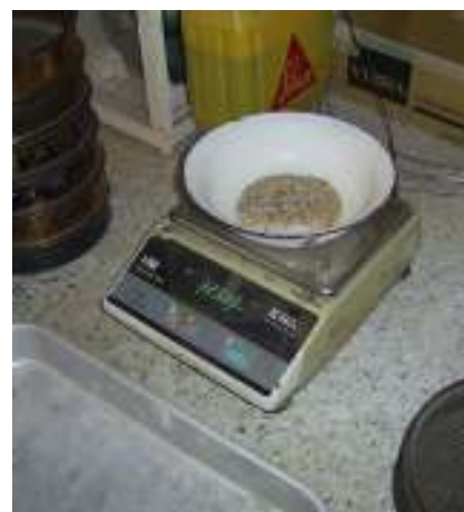
รูปที่ 1.4 ชั่งน้ำหนักตัวอย่างที่ค้างตะแกรง แต่ละขนาด
