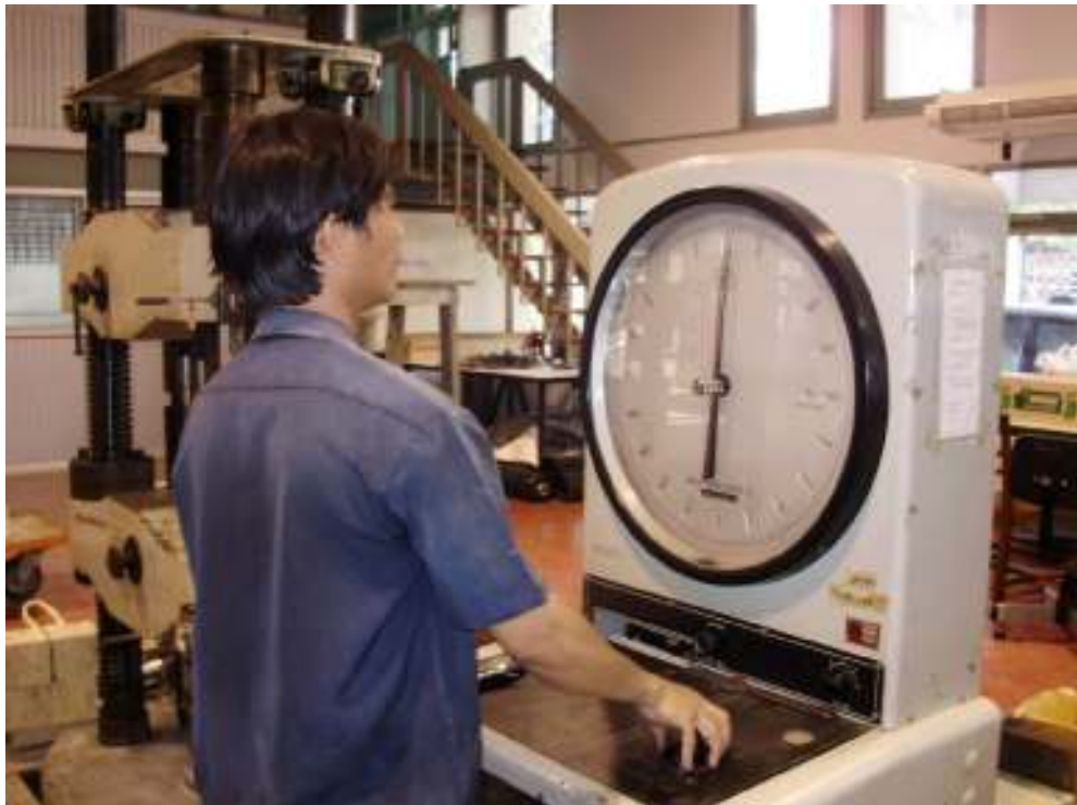
รูปที่ 5 การทดสอบกำลังอัดโดยให้น้ำหนักกดเป็นไปอย่างสม่ำเสมอ
