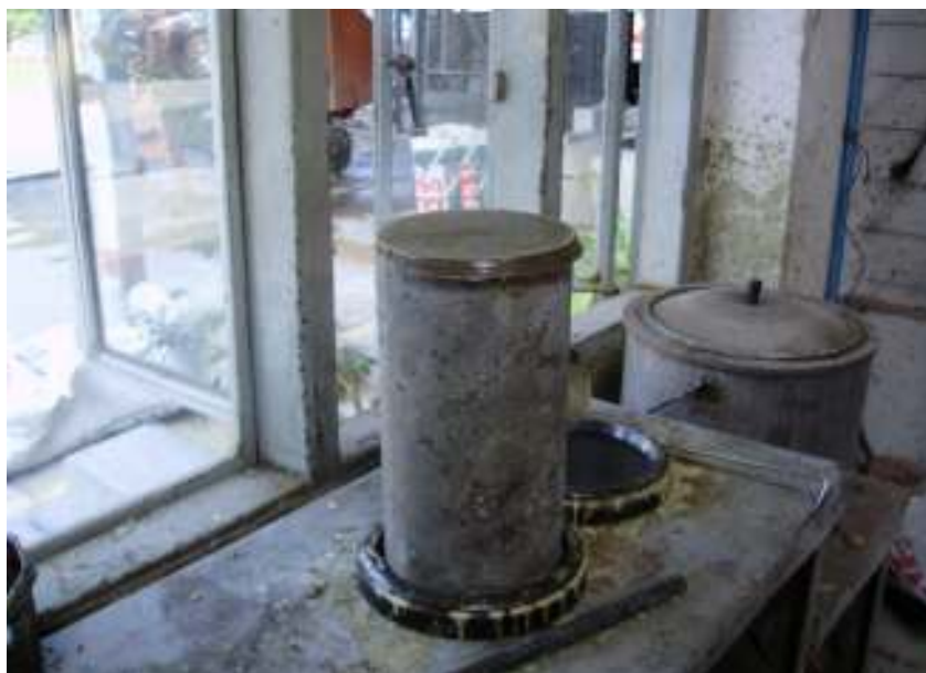
รูปที่ 3 การเคลือบผิวหน้าแท่งตัวอย่างรูปทรงกระบอกด้วยก้ำมะถันห่อมเหลว
