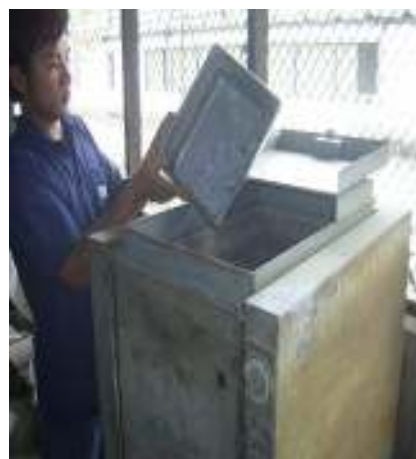
รูปที่ 4 แยกตัวอย่างออกจากลูกเหล็กหลังจากหมุนเครื่องครบตามจำนวนรอบที่กำหนด
