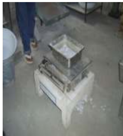
รูปที่ 6 ชั่งตัวอย่างที่ค้างตะแกรงเบอร์ 12 เพื่อหาน้ำหนักหลังการทดสอบ
