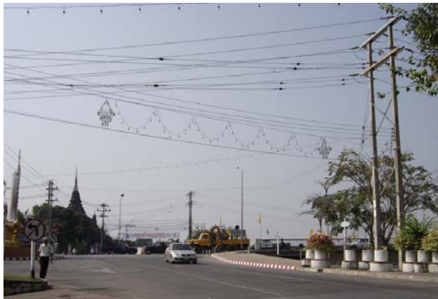
รูปที่ 3-18 แสดงระบบจำหน่ายแรงสูงบนเสา H-Frame บดบังทัศนียภาพ
