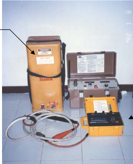
รูปที่ 4.37 แสดง DC Hi-Pot Test Set และ Megohmmeter
