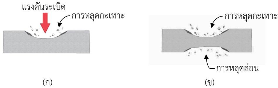
รูปที่ 6-4 การวิบัติแบบหลุดกะเทาะและแบบหลุดล่อน
