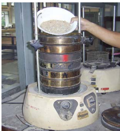
รูป ๑.๑ ติดตั้งตะแกรงกับเครื่องเขย่า ใส่ตัวอย่างที่เตรียมไว้ลงไป
