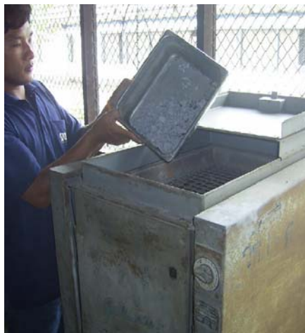
รูป ๒.๑ ติดตั้งตะแกรงกับเครื่อง ใส่ตัวอย่างที่เตรียมไว้ลงไป
