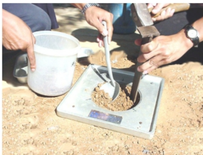
รูปที่ ๒ การทดสอบความแน่นในสนาม
