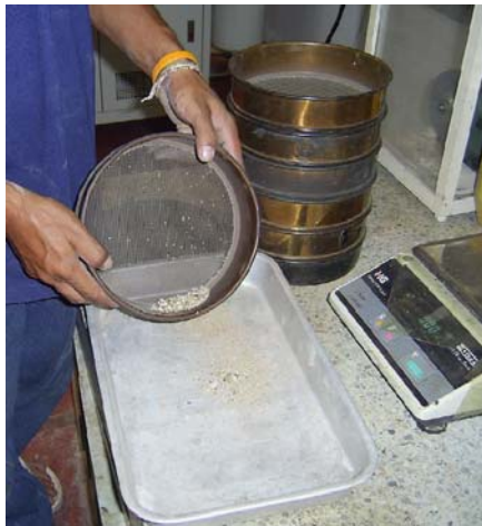
รูปที่ ๑.๓ แยกตัวอย่างที่ค้ำบนแต่ละตะแกรง รูปที่ ออกจากตะแกรง แต่ละขนาด
