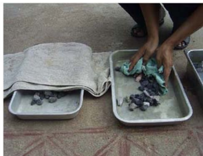
รูปที่ ๑ สุ่มตัวอย่างด้วยเครื่องแบ่งตัวอย่างรูปที่ ๒ เช็ดตัวอย่างที่แช่น้ำไว้ให้มีสภาพ
