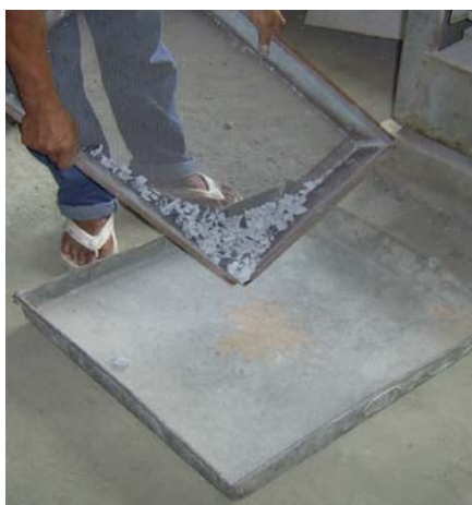
รูปที่ ๒.๓ แยกตัวอย่างที่ค้ำแต่ละตะแกรง รูปที่ ๒.๔ ชั่งน้ำหนักตัวอย่างที่ค้ำตะแกรงแต่ละขนาด ออกจากตะแกรง
