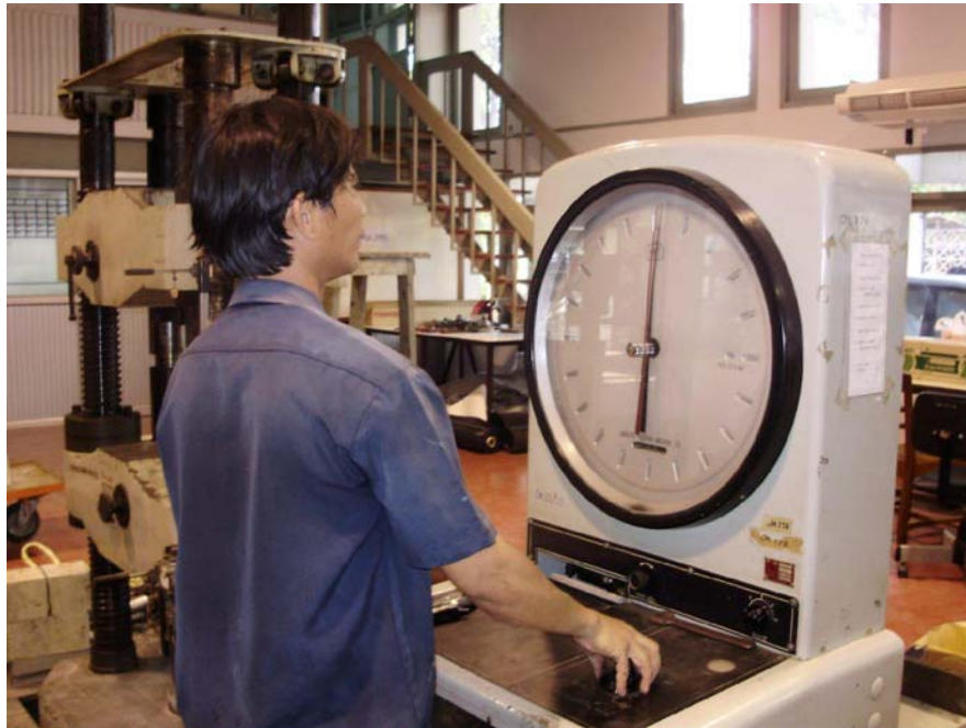
รูปที่ ๕ การทดสอบกำลังอัดโดยให้น้ำหนักกดเป็นไปอย่างสม่ำเสมอ ๓.๕ กดแท่งตัวอย่างจนวิบัติ บันทึกค่าแรงกดที่ได้ แล้วนำค่าแรงกดแรงกดและพื้นที่หน้าตัดที่ได้มาหาค่ากำลังอัดต่อไป
