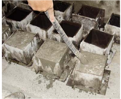
รูปที่ ๒ การหล่อแท่งคอนกรีตโดยใช้เครื่อง สั่นคอนกรีตชนิดจุ่ม
