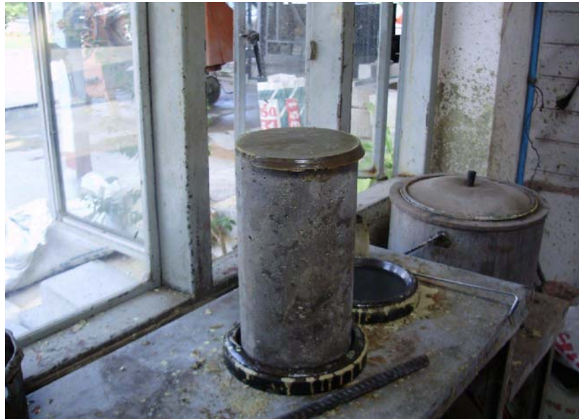
รูปที่ ๓ การเคลือบผิวหน้าแท่งตัวอย่างรูปทรงกระบอกด้วยกัมมะถันหลอมเหลว
