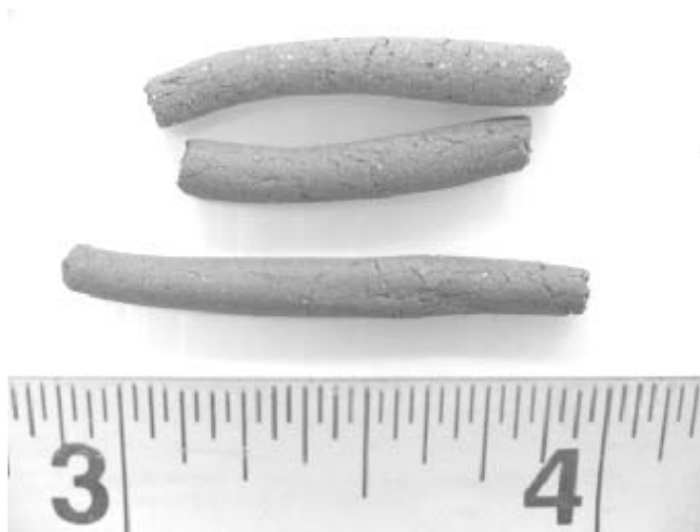
รูปที่ ๓ ลักษณะรอยแตกบนผิวดินของเส้นตัวอย่าง
