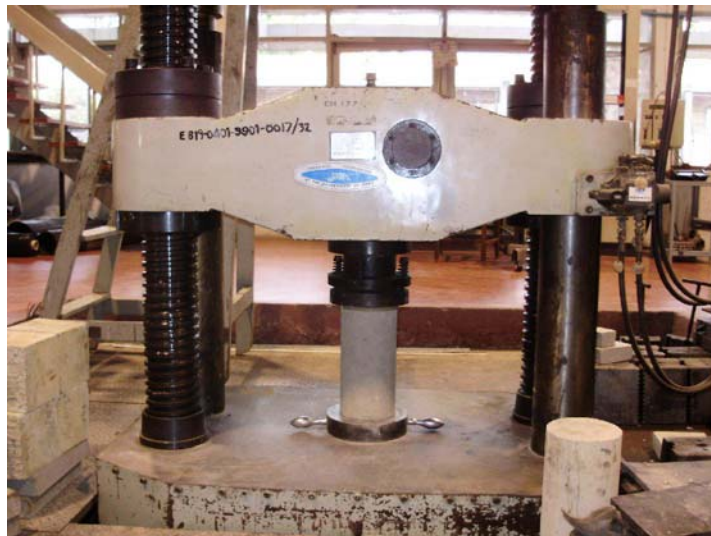
รูปที่ ๔ การนำแท่งตัวอย่างบนกึ่งกลางของแท่นทดสอบ
