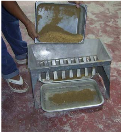
รูปที่ ๒ แบ่งตัวอย่างทรายด้วยเครื่องแบ่งตัวอย่าง
