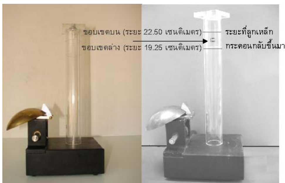
รูปผนวกที่ ๑ ทดสอบการกระดอนบนแท่นยางของอุปกรณ์ทดสอบ Liquid Limit
