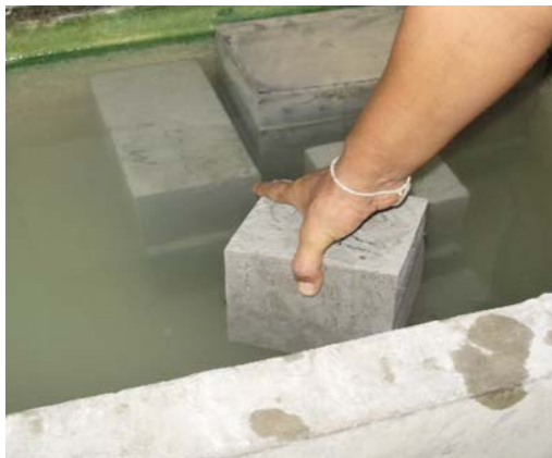
รูปที่ ๓ การบ่มแท่งตัวอย่างด้วยน้ำ
