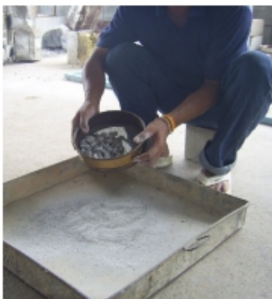
รูปที่ ๕ ร่อนตัวอย่างด้วยตะแกรงเบอร์ ๑๒ รูปที่ ๖ ชั่งตัวอย่างที่ค้างตะแกรงเบอร์ ๑๒ เพื่อหาน้ำหนักหลังการทดสอบ
