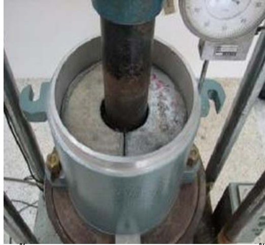
รูปที่ ๓ การตั้งให้แท่งกดอยู่ตรงพอดีกับรูตรงกลางของน้ำหนักรีดทับ
