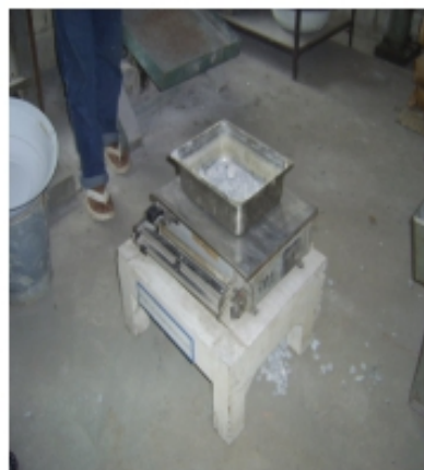
รูปที่ ๕ ร่อนตัวอย่างด้วยตะแกรงเบอร์ ๑๒ รูปที่ ๖ ชั่งตัวอย่างที่ค้างตะแกรงเบอร์ ๑๒ เพื่อหาน้ำหนักหลังการทดสอบ
