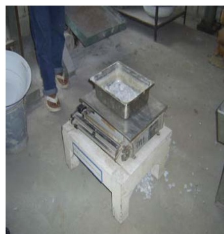
รูปที่ ๒.๓ แยกตัวอย่างที่ค้ำแต่ละตะแกรง รูปที่ ๒.๔ ชั่งน้ำหนักตัวอย่างที่ค้ำตะแกรงแต่ละขนาด ออกจากตะแกรง
