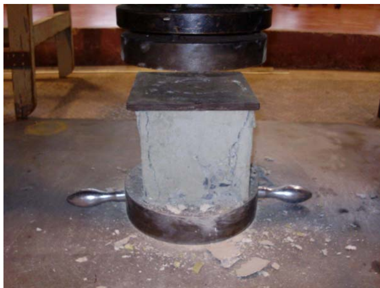
รูปที่ ๖ แท่งตัวอย่างรูปทรงลูกบาศก์ที่กดจนวิบัติ
