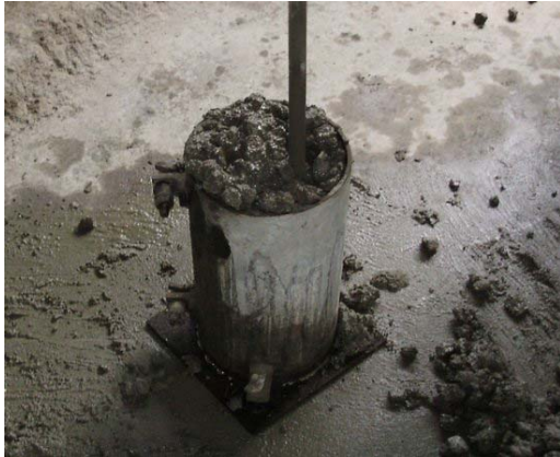
รูปที่ ๑ การหล่อแท่งคอนกรีตโดยใช้เหล็กกระทุ้ง
