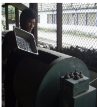
รูปที่ ๓ ใส่ตัวอย่างและลูกเหล็กลงใน
