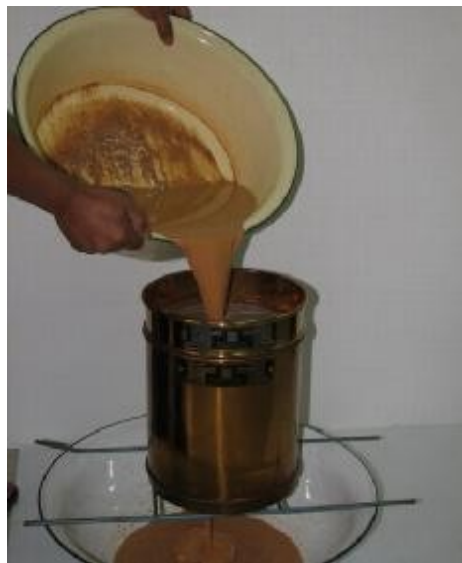
รูปที่ ๓ การล้างตัวอย่างผ่านตะแกรงเบอร์ ๒๐๐ โดยมีตะแกรงเบอร์ ๑๖ วางซ้อนไว้ด้านบน
