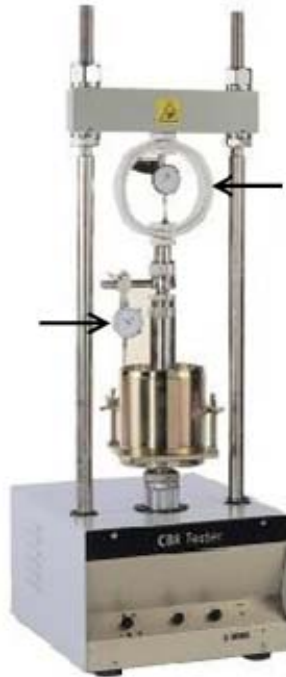
รูปที่ ๔ การทดสอบแรงกดที่ระยะจมนต่างๆ ของแท่งกดบนตัวอย่างทดสอบ
