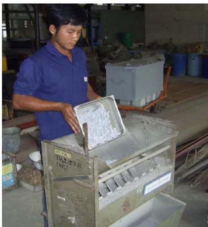
รูปที่ ๑ สุ่มตัวอย่างด้วยเครื่องแบ่งตัวอย่างรูปที่ ๒ เช็ดตัวอย่างที่แช่น้ำไว้ให้มีสภาพ
