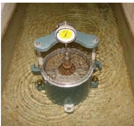
รูปที่ ๒ วิธีวัดค่าการบวมตัวของตัวอย่าง ทดสอบแบบแช่น้ำ
