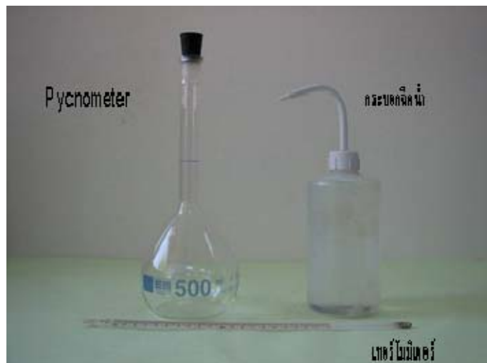
รูปที่ ๑ Pycnometer แบบ Volumetric Flask, เทอร์โมมิเตอร์ และกระบอกฉีดน้ำ
