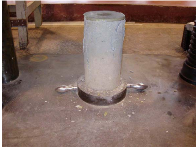
รูปที่ ๗ แท่งตัวอย่างรูปทรงกระบอกที่กวดจนวิบัติ
