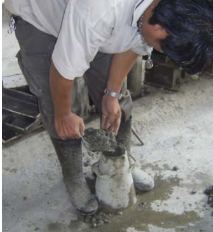
รูปที่ ๒ ตักคอนกรีตใส่กรวย ๑/๓ ของปริมาตร
