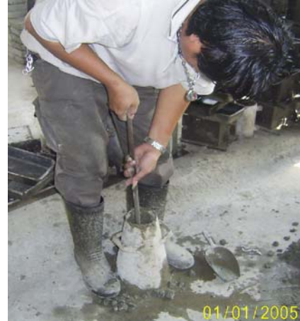
รูปที่ ๓ กระทบชั้นละ ๓ ชั้นๆ ๒๕ ครั้ง
