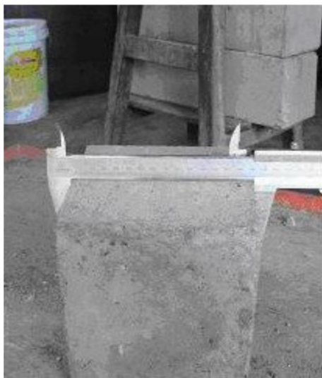
รูปที่ ๑ วัดขนาดแท่งตัวอย่างรูปทรง ลูกบาศก์
