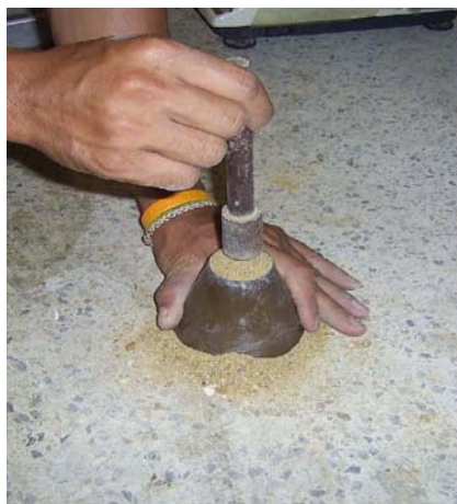
รูปที่ ๔ ใช้แท่งดำโลหะตักกระทบบตัวอย่าง
