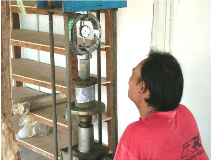
รูปที่ 9 ทดลองหาค่ากำลังรับแรงอัดของดินซีเมนต์โดยวิธี Unconfined Compression Test
