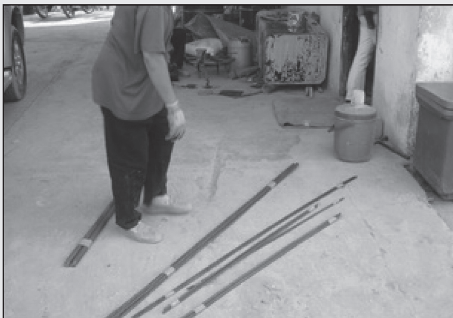
รูปที่ 2-7 การเก็บตัวอย่างลวดเหล็กอัดแรงและเหล็กเสริม
