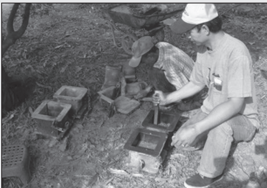
รูปที่ 2-9 การเก็บตัวอย่างคอนกรีตรูปลูกบาศก์ ขนาด 15 x 15 x 15 เซนติเมตร
