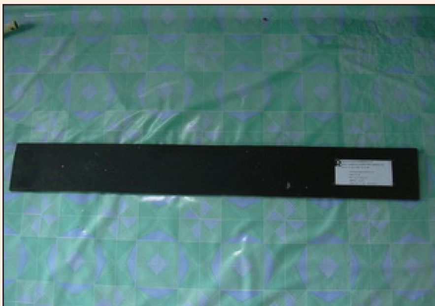
รูปที่ 2-11 ตัวอย่างแผ่นยางรองพื้นสะพานรองรับคานแบบแผ่นพื้น (Plank Girder)
