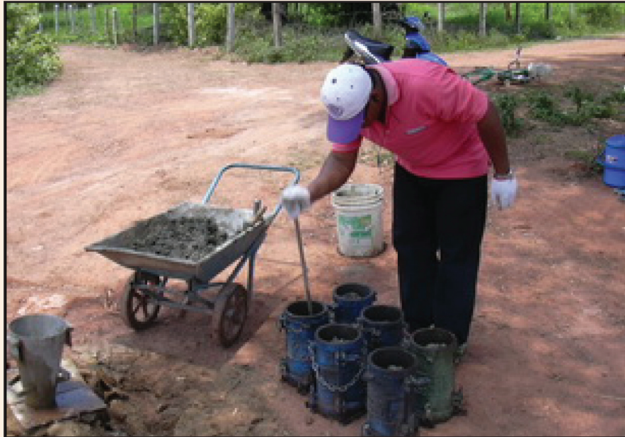
รูปที่ 2-10 การเก็บตัวอย่างคอนกรีตรูปทรงกระบอก ขนาดเส้นผ่านศูนย์กลาง 15 x 30 เซนติเมตร
