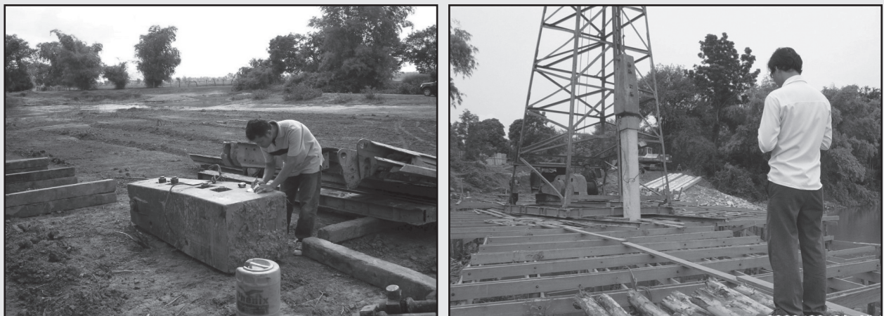
รูปที่ 3-20 การวัดขนาดลูกตุ้มเพื่อคำนวณหาน้ำหนัก
