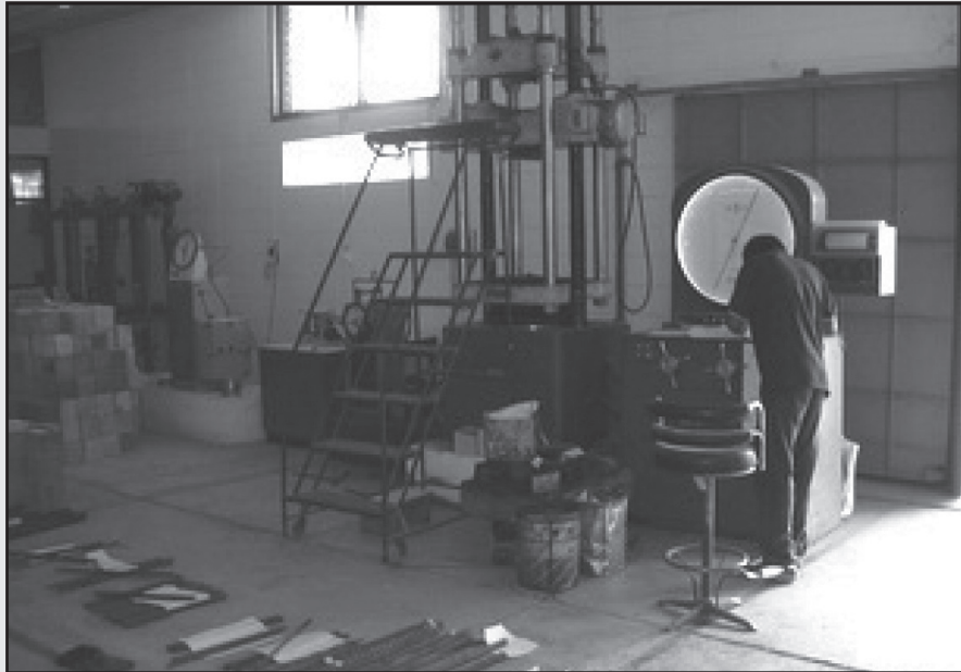
รูปที่ 2-6 เครื่องทดสอบความต้านทานแรงดึงวัสดุเหล็กเสริมและลวดอัดแรง
