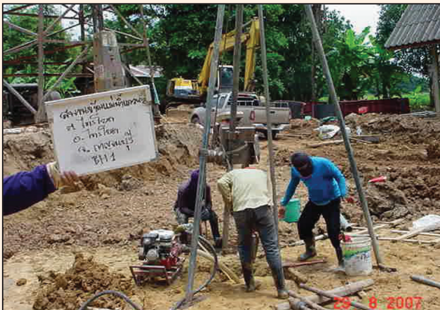
รูปที่ 2-12 การเจาะสำรวจชั้นดินโดยวิธี Standard Penetration Test (SPT)
