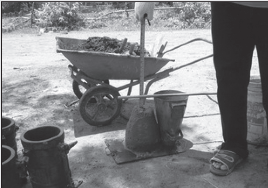
รูปที่ 2-8 การทดสอบค่ายุบตัวของคอนกรีต (Slump Test)
