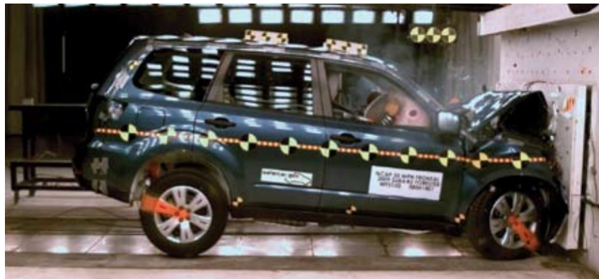
รูปที่ 4 การทดสอบรถยนต์กระแทกกับราวกันตก
