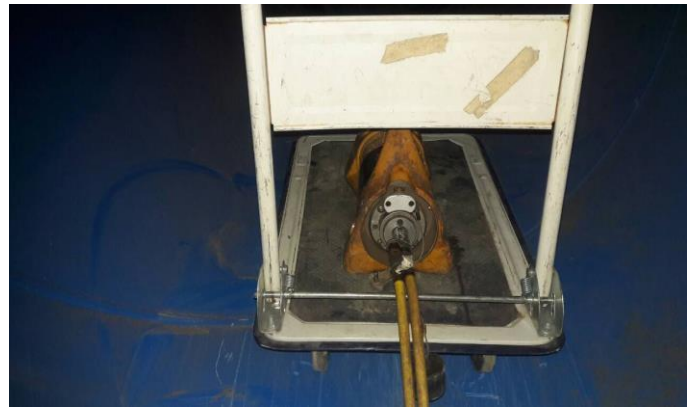
หาตำแหน่งการวางเครื่องกำเนิดรังสี เพื่อเตรียมการตรวจสอบ
