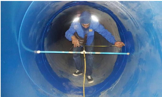
ปรับตั้งหัวจากรังสีเพื่อการถ่ายภาพ ในระนาบเดียวกับแนวเชื่อมต่อที่จุดศูนย์กลางของท่อ
