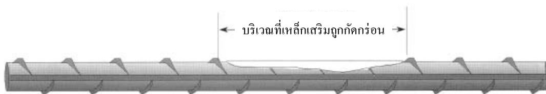
รูปที่ 18 บริเวณเหล็กเสริมที่มีการกัดกร่อนเป็นสนิม (ที่มา: ICRI 03730) (ข้อ 5.4.5)
