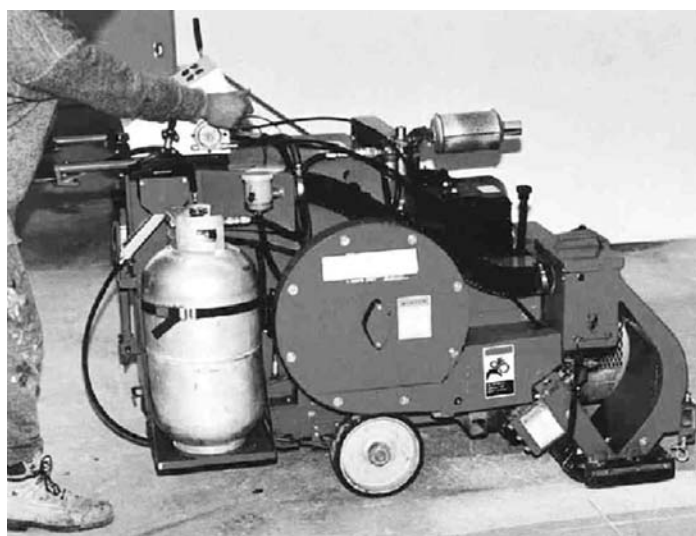
รูปที่ 12 การสกัดด้วยการพ่นอนุภาคโลหะ (Shotblasting) (ต่อ) (ที่มา: ACI 555) (ข้อ 5.2.2.4)
