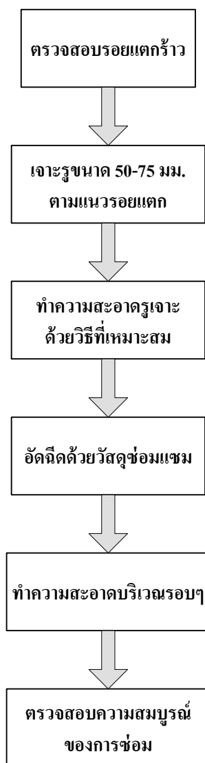
รูปที่ 59 วิธีการเจาะเพื่ออุดด้วยวัสดุซ่อมแซม (ข้อ 7.11, 7.11.3.3)
