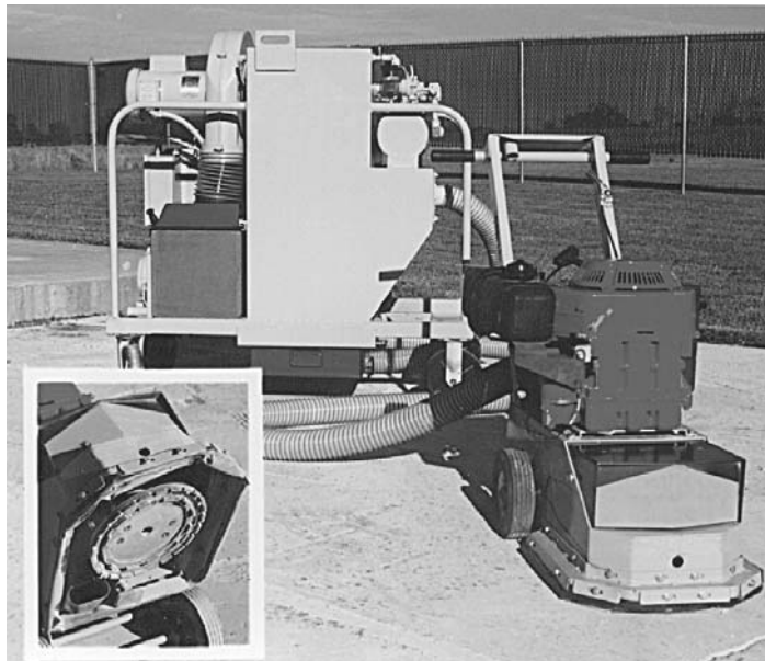
รูปที่ 13 เครื่องมือขัด (Grinding) (ที่มา: ICRI 03732)
