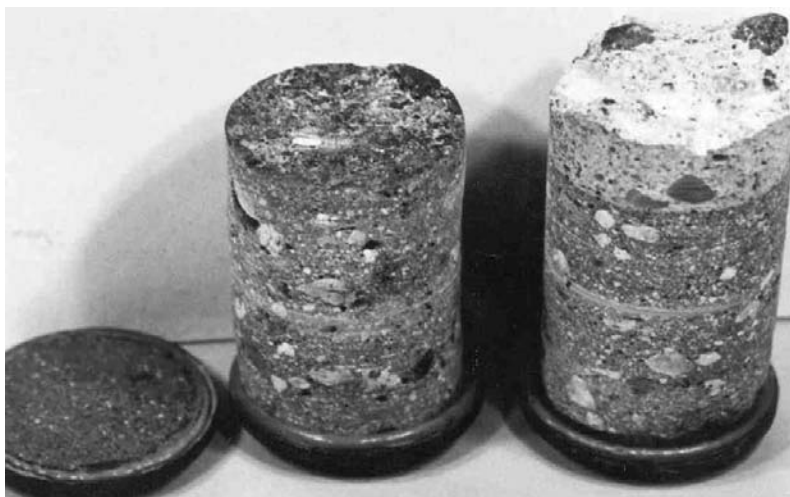
รูปที่ 31 แท่งคอนกรีตที่ผ่านการทดสอบการยัดเกาะของคอนกรีต (ที่มา: ACI 555)
