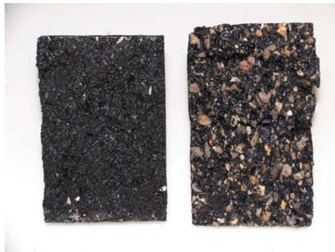
รูปที่ ๒ แท่งตัวอย่างแอสฟัลต์คอนกรีตในสภาพปกติ (ซ้าย) และแท่งตัวอย่างแอสฟัลต์คอนกรีตที่ได้รับ ความเสียหายจากความชื้น ทำให้เกิดการหลุดลอก (ขวา)
