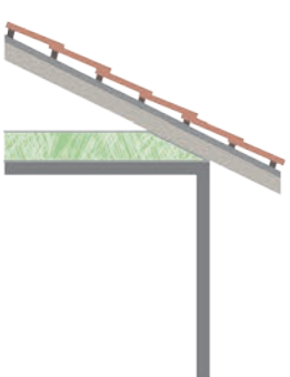
4 ติดตั้งฉนวนใยแก้วหุ้มแผ่นสะท้อนความร้อนชนิดวางบนฝ้าเพดาน
