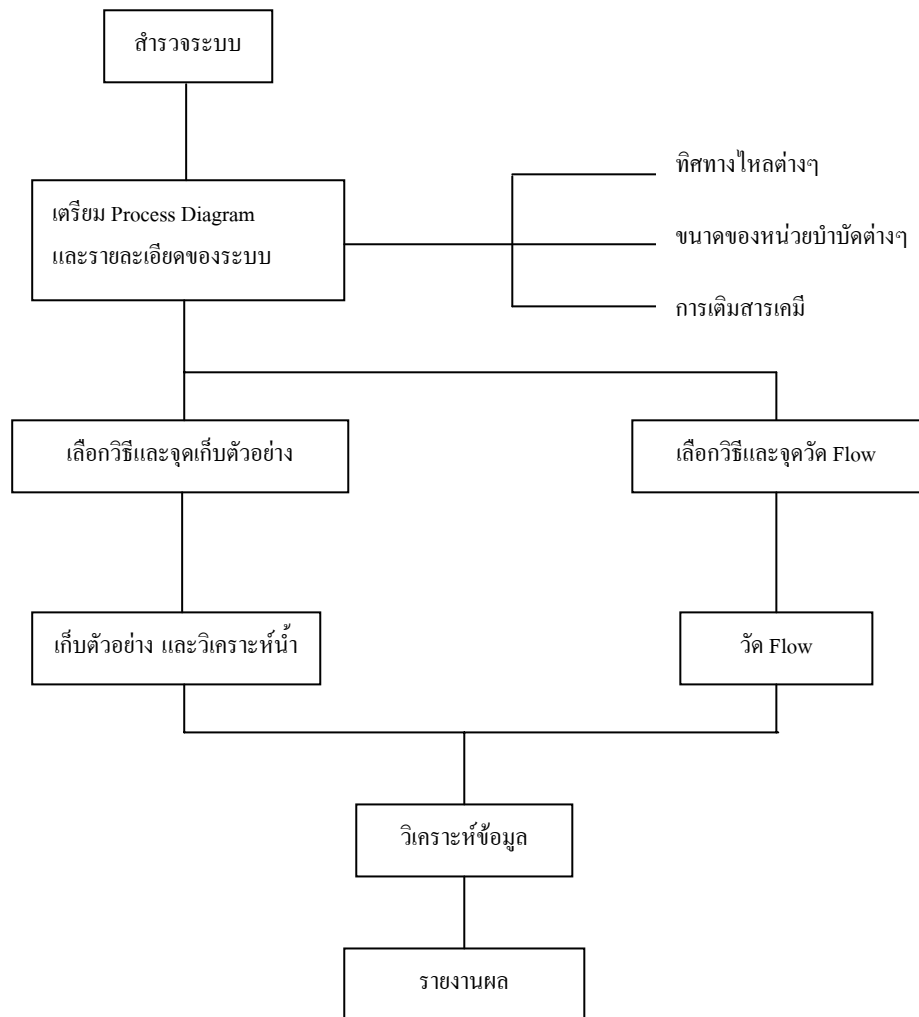
รูปที่ 3-6 ขั้นตอนการตรวจสอบสมรรถนะของระบบบำบัดน้ำเสีย
