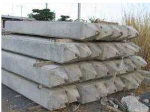
รูปที่ 3.23 แสดงเสาเข็มสี่เหลี่ยมตัน (Square)
