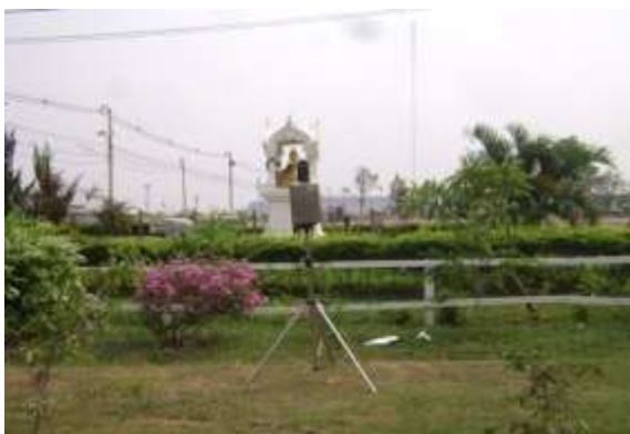
รูปที่ 8.19 การตรวจวัดเสียงต้องทำการวัดเป็น เวลาอย่างน้อย 24 ชั่วโมง โดยหน่วยงาน สิ่งแวดล้อมของรัฐ
