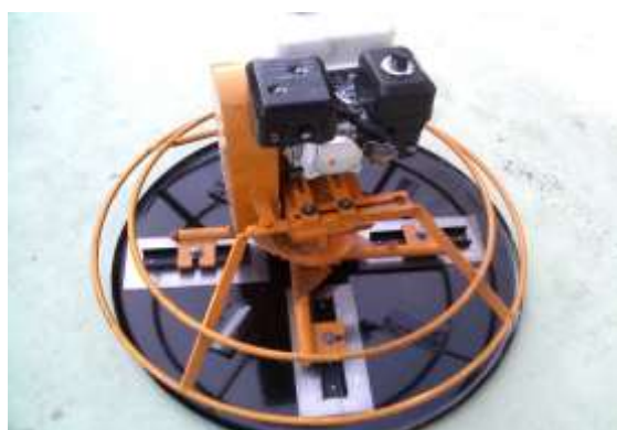
รูปที่ 7.31 เครื่องขัดประกอบอุปกรณ์งานขัด ปรับระดับ
