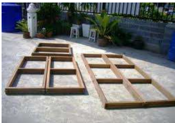
รูปที่ 7.71 วงกบไม้ปัจจุบันจะจำหน่ายเป็นชิ้นส่วนเพื่อสะดวกในการขนส่ง ผู้ใช้ต้องประกอบขึ้นเอง
