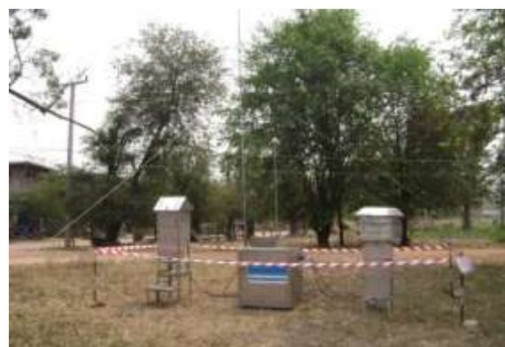
รูปที่ 8.18 เครื่องตรวจวัดคุณภาพอากาศตั้งไว้ใน บริเวณโครงการและบริเวณใต้ลมโดยหน่วยงาน สิ่งแวดล้อมของรัฐ
