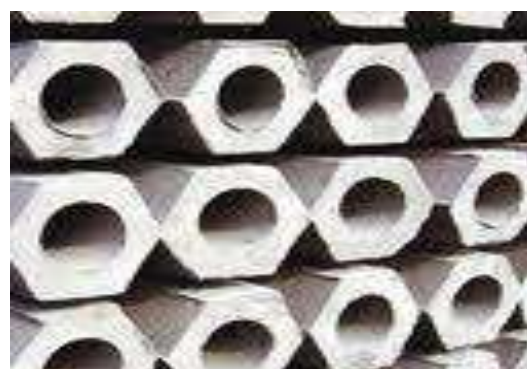
รูปที่ 3.26 แสดงเสาเข็มหกเหลี่ยม (ด้านหน้าเข็มตัดวางอยู่บนดิน)
