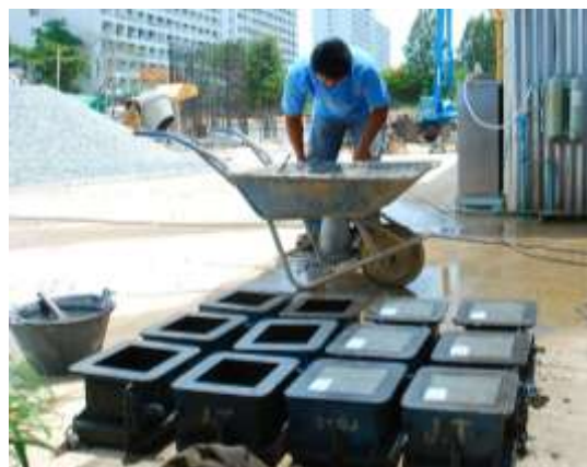
รูปที่ 4.65 การเก็บตัวอย่างคอนกรีตหน้างาน
