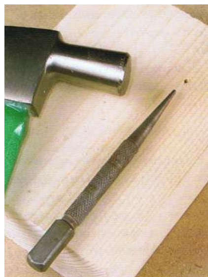
รูปที่ 4.20 เหล็กส่งสำหรับซ่อนหัว ตะปูในการปูพื้นไม้รางลิ้น
