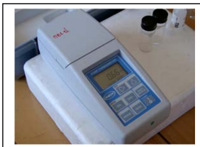
(7) กดปุ่ม Read จอปรากฏ ".....NTU" เมื่อค่าที่วัดหยุดกระพริบ จึงอ่านและบันทึกค่าความขุ่นของน้ำตัวอย่าง
