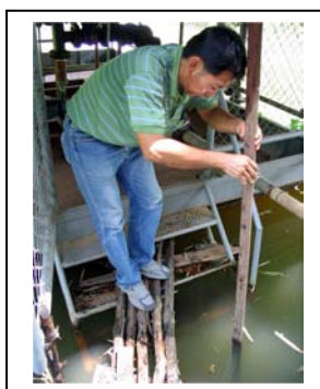
รูปที่ 8 วิธีการวัดความขุ่นโดยการวัดระยะความลึกจากการมองเห็น
