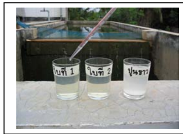
4. ใช้หลอดดูดน้ำปูนขาวที่เตรียมไว้ในข้อ (3) หยดลงใน แก้วน้ำดิบแก้วใดแก้วหนึ่ง ประมาณ 6 – 7 หยด
