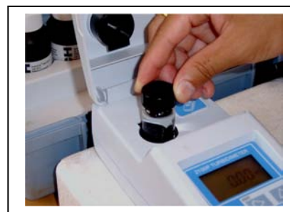
(4) นำขวดใส่ตัวอย่างน้ำ วางลงในช่องใส่ตัวอย่าง โดยหันด้านที่มีลูกศรให้ตรงกับสัญลักษณ์เดียวกันที่ตัวเครื่อง ปิดฝา
