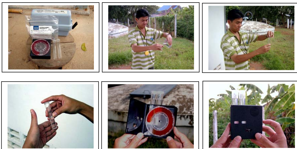
รูปที่ 77 การวิเคราะห์ปริมาณคลอรีนหลงเหลือ โดยวิธีการเทียบสี
