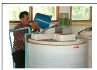
(3) เติมผงสารส้มทุบละเอียดผสมกับน้ำที่เตรียมไว้
