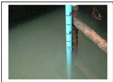
(1) การทำเครื่องหมายที่ท่อพีวีซี
