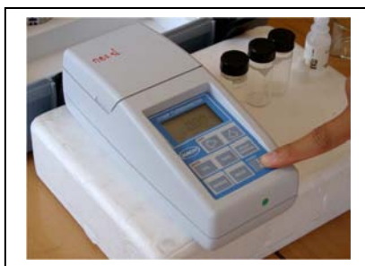
(3) วางตัวเครื่องไว้บนพื้นโต๊ะหรือพื้นที่ราบ แล้วกดปุ่ม I/O เปิดเครื่อง
