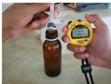
รูปที่ 55 การหาอัตราการจ่ายสารละลายคลอรีนโดยวิธีการตวงจับเวลา
