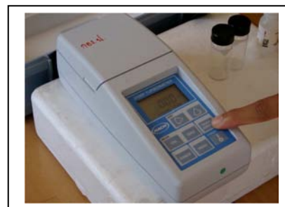
(6) กดปุ่ม Signal Average หน้าจอจะปรากฏ "SIG AVG" เพื่ออ่านค่าเฉลี่ยในการวัด
