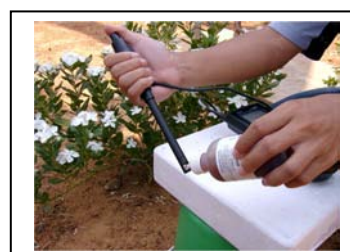
(4) ล้างหัววัดพี เอช มิเตอร์ด้วยน้ำกลั่นหรือน้ำดื่ม
