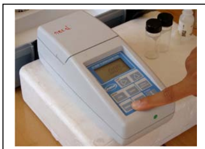
(5) กดปุ่ม Range เพื่อเลือกช่วงในการวัดโดยให้หน้าจอปรากฏ "AUTO" เครื่องจะทำการเลือกช่วงในการวัดอัตโนมัติ
