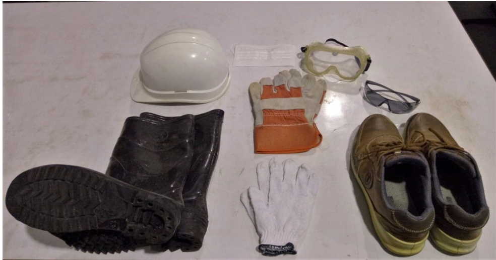
รูปที่ 24 ตัวอย่างอุปกรณ์ความปลอดภัยสำหรับผู้ติดตั้ง (ข้อ 2.7.1)
