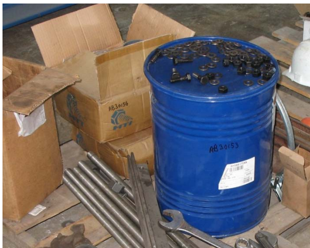
รูปที่ 17 ตัวอย่างการเก็บสลักเกลียวและแป้นเกลียวในภาชนะบรรจุจนกว่าจะมีการใช้งาน (ข้อ 2.6.3)
