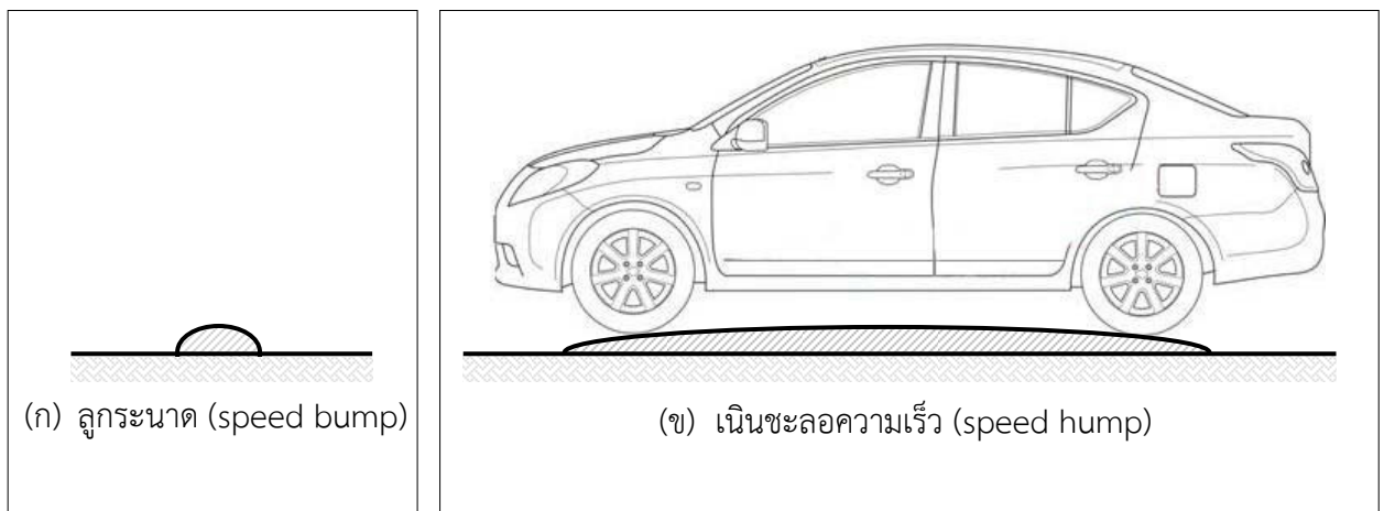
รูปที่ 2 ประเภทของสันชะลอความเร็วที่พบได้โดยทั่วไป (ก) ลูกกระพรวน (ข) เนินชะลอความเร็ว
