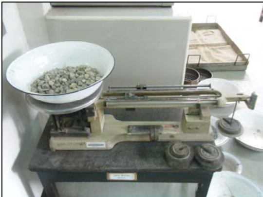
6.7 นำไปชั่งหามวลให้ได้ความละเอียดร้อยละ 0.1 บันทึกเป็นมวลสุดท้ายของการทดลอง
