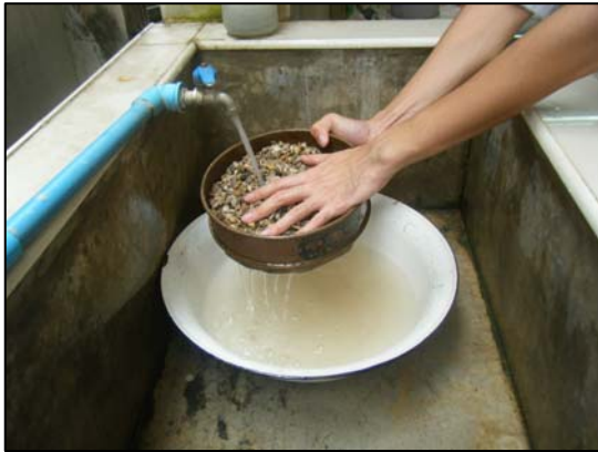
6.5 ล้างวัสดุตัวอย่างผ่านตะแกรงตามขนาดที่ระบุในตารางที่ 2
