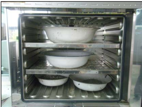
6.6 อบตัวอย่างที่ค้างบนตะแกรงแต่ละขนาดตามข้อ 2.5.4 ให้แห้งที่อุณหภูมิ 110 \pm 5 องศาเซลเซียส
