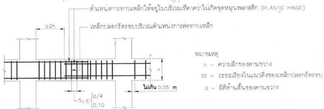
รูปที่ 5.5-5 ตัวอย่างการให้รายละเอียดระยะทาประหว่างเหล็กเสริมในคานขวางของตอม่อ
