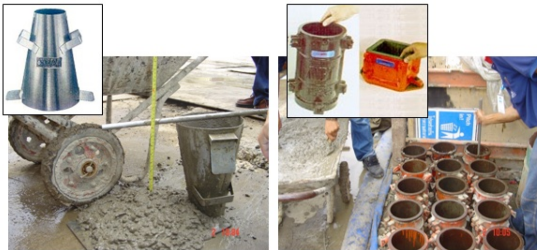
การเก็บตัวอย่างเพื่อทดสอบกำลัง อัดทรงกระบอก ASTM C 78
