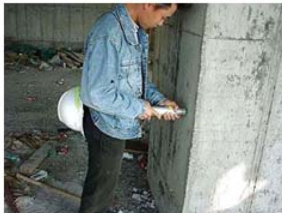
ภาพแสดงการทดสอบกำลังด้วยวิธี Rebound Hammer test
