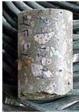
ภาพแสดง การทำ Coring ตัวอย่างลูกปูน
