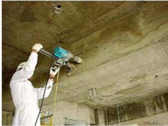
ภาพแสดง การทำ Coring ตัวอย่างลูกปูน
