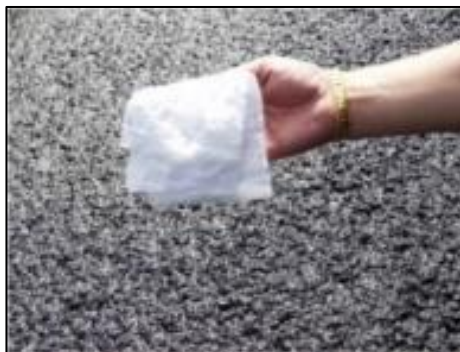
รูปที่ 1 การใช้กระดาษซับ เพื่อหา Initial Set Time
