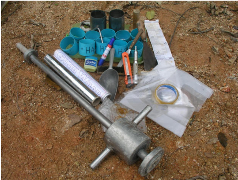
รูปที่ 7 ชุดเครื่องมือเก็บตัวอย่าง KU-miniature sampler (ข้อ 4.1.1.6)
