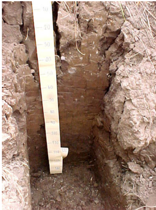
รูปที่ 4 ลักษณะการเปิดบ่อสำรวจดิน (ข้อ 4.1.1.4)
