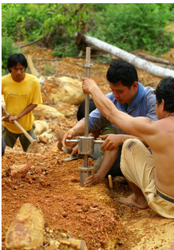
รูปที่ 6 ตัวอย่างการเก็บตัวอย่างดินและหินโดยใช้ KU-miniature sampler ในบริเวณพื้นที่ลาดชัน (ข้อ 4.1.1.6)
