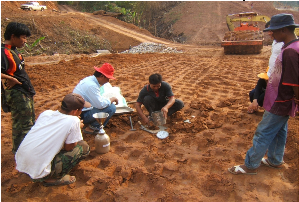
รูปที่ ๘ ตัวอย่างการทดสอบหาความแน่นของดินในสนาม
