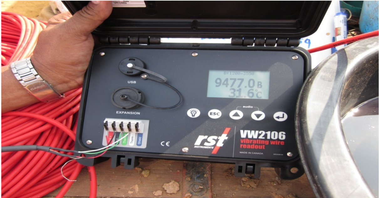
รูปที่ ๓๔ ตัวอย่างค่าที่อ่านได้จากเครื่อง Readout Unit
