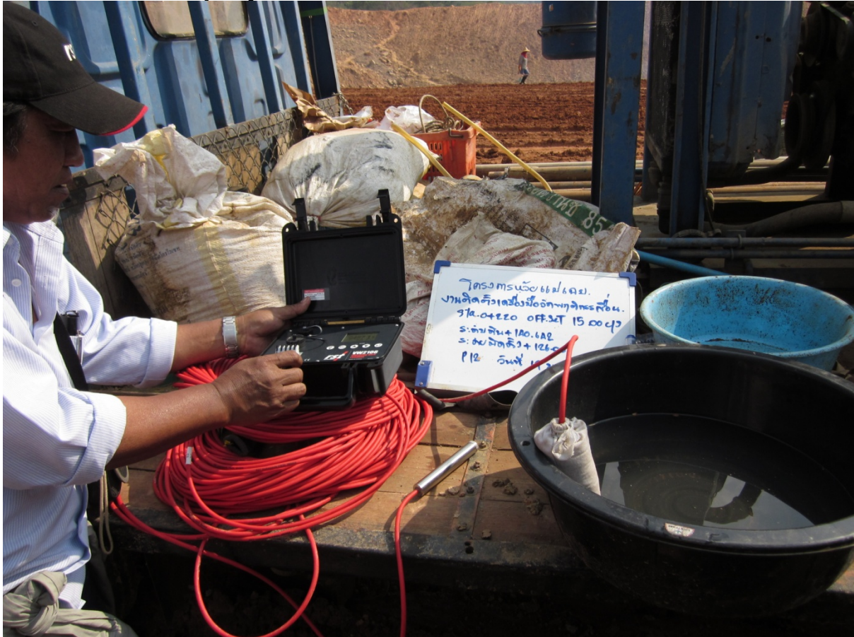
รูปที่ ๓๓ การอ่านค่าเริ่มต้นจากเครื่อง Readout Unit
