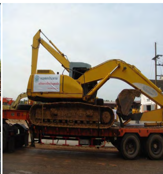
แสดงลักษณะขนย้ายรถขุดไฮดรอลิกชนิดแขนสั้น [HB-CM] ด้วยรถบรรทุกลากจูง
