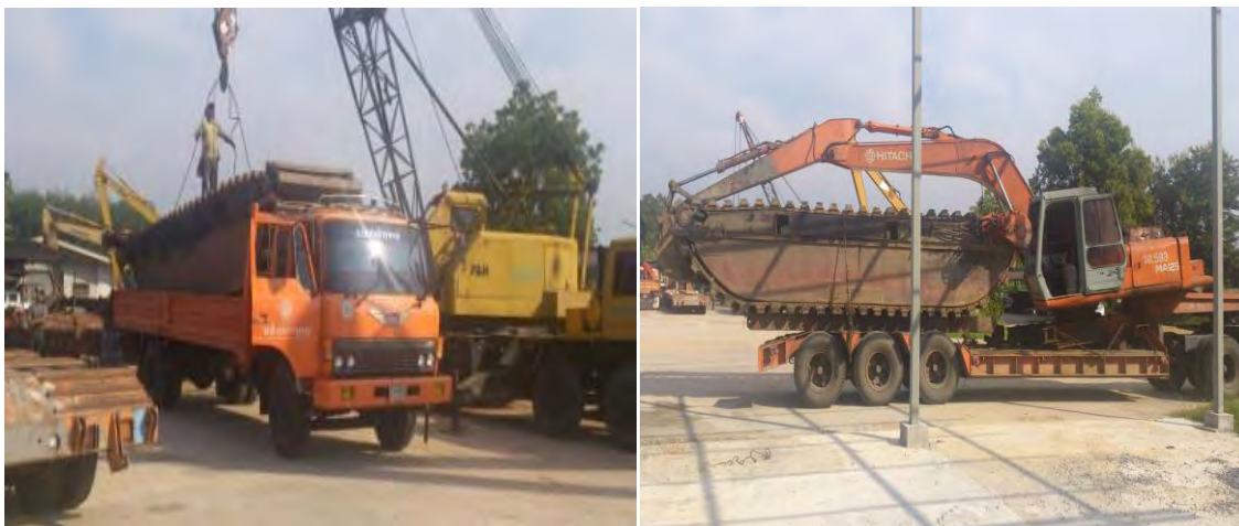
แสดงลักษณะขนย้ายรถชุดชนิดโป๊ะเหล็ก [MB] ด้วยรถบรรทุก
