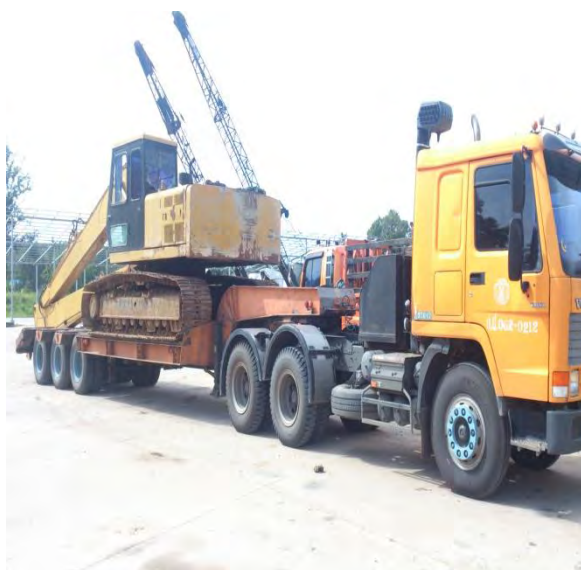
แสดงลักษณะขนย้ายรถขุดไฮดรอลิกชนิดแขนยาว [HB-LR] ด้วยรถบรรทุกลากจูง
