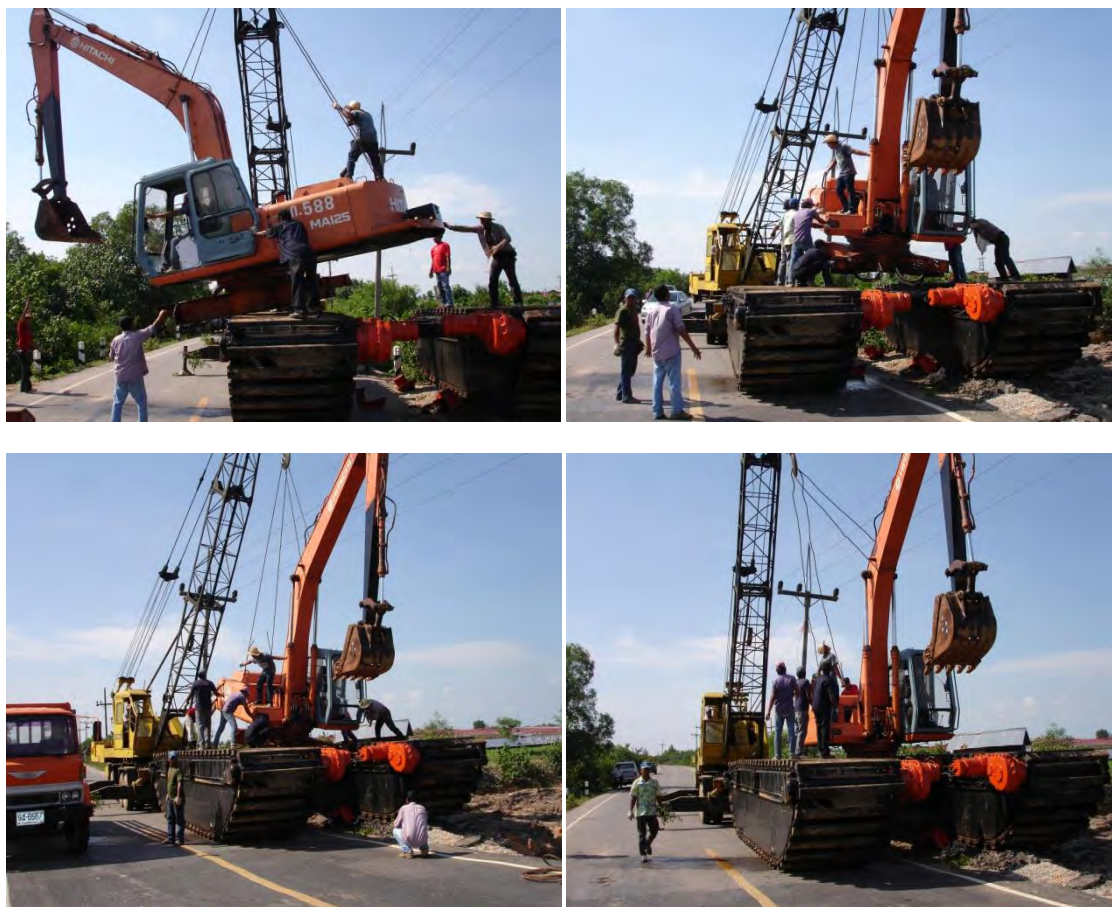
แสดงลักษณะการประกอบชิ้นส่วนและอุปกรณ์ของรถขุดชนิดโป๊ะเหล็ก [MB] ที่สมบูรณ์
