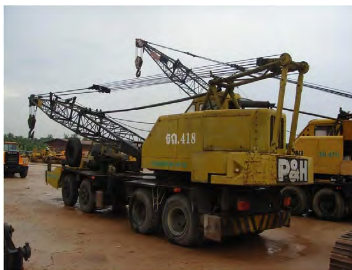
แสดงลักษณะรถขุดปั้นจั่นชนิดล้อยางติดอุปกรณ์ยกติดปั๊نگี้
