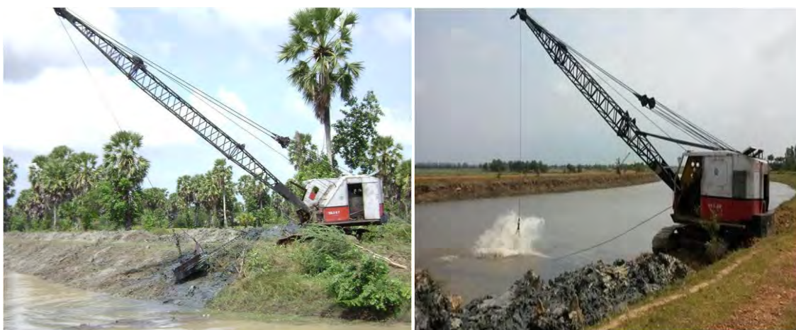
แสดงลักษณะรถขุดชนิดตีนตะขากขุดที่ลาก (Dragline Excavator Crawler Mounted)
