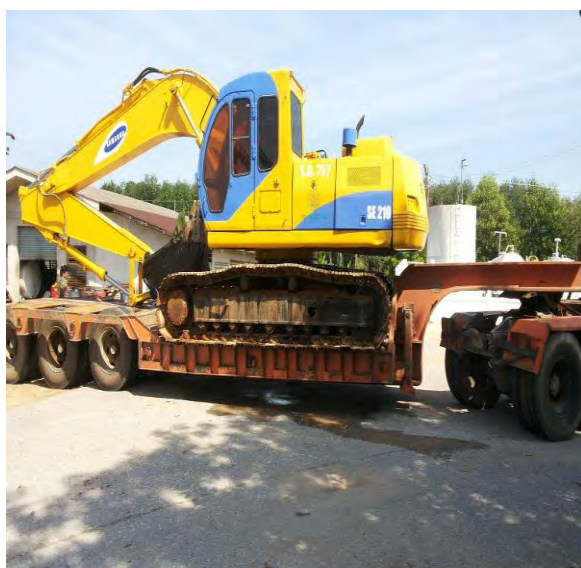
แสดงลักษณะขนย้ายรถขุดไฮดรอลิกชนิดแขนสั้น [HB-CM] ด้วยรถบรรทุกลากจูง
