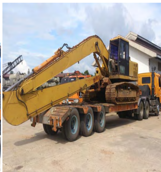
แสดงลักษณะขนย้ายรถขุดไฮดรอลิกชนิดแขนยาว [HB-LR] ด้วยรถบรรทุกลากจูง
