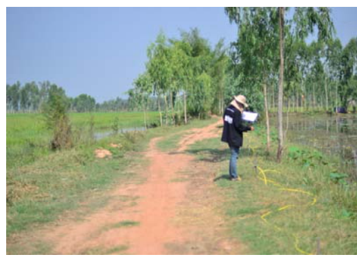
รูปที่ 2-5 แสดงการสำรวจธรณีฟิสิกส์แบบ 2 มิติ จัดวางขั้วไฟฟ้าแบบ dipole-dipole
