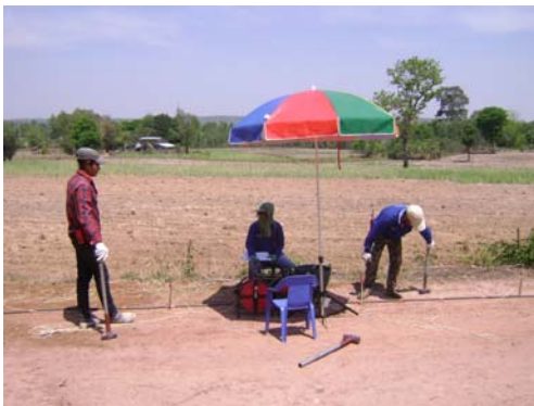
รูปที่ 2-4 แสดงการสำรวจธรณีฟิสิกส์ตัวอย่าง การจัดวางขั้วไฟฟ้าแบบ Schlumberger
