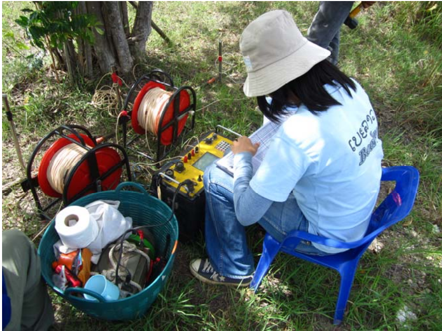
รูปที่ 3.6 การสำรวจความต้านทานไฟฟ้าจำเพาะแบบ 1 มิติ โดยเครื่อง SuperString™ R8/IP เพื่อหาค่าการเปลี่ยนแปลงในแนวตั้ง
