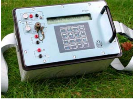
ก. เครื่องมือวัดค่าความต้านทานไฟฟ้าจำเพาะ ยี่ห้อ IRIS
