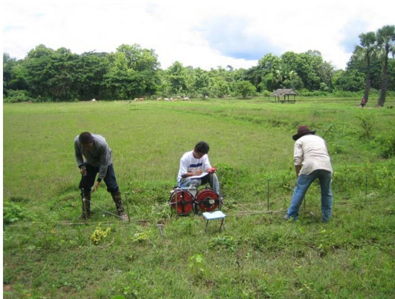
รูปที่ 3.3 การสำรวจความต้านทานไฟฟ้าจำเพาะโดยเครื่อง IRIS รุ่น SYSCAL R-1 Plus เพื่อหาค่าการเปลี่ยนแปลงในแนวดิ่ง
