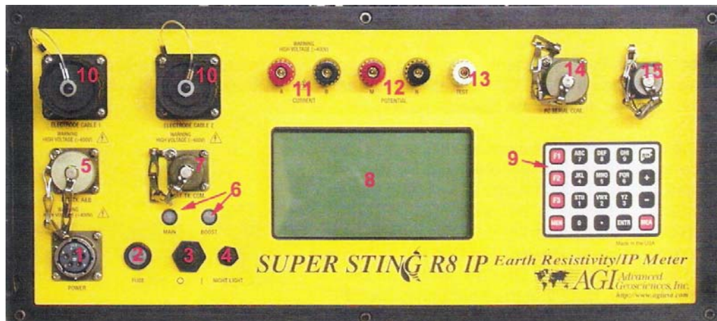
รูปที่ 3.5 ส่วนประกอบของแผงควบคุม ของเครื่องสำรวจ SuperString™ R8/IP
