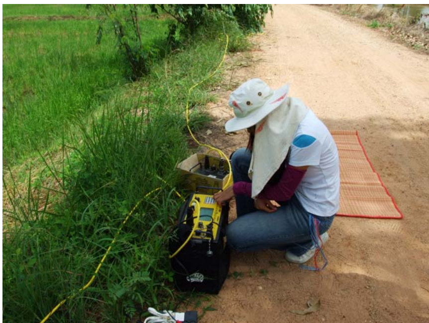
รูปที่ 3.7 การสำรวจความต้านทานไฟฟ้าจำเพาะแบบ 2 มิติ โดยเครื่อง SuperString™ R8/IP
