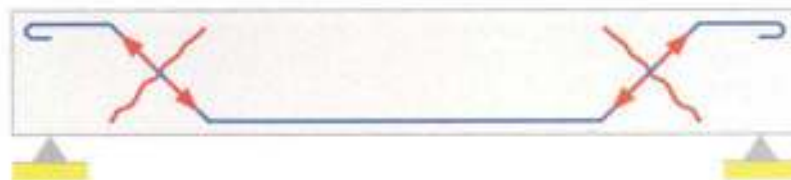
รูปที่ 2.15 การเสริมเหล็กคอม้ารับแรงเฉือน
