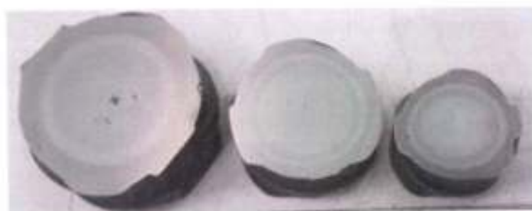
รูปที่ 1.6 หน้าตัดเหล็กเส้นที่ผ่านกรรมวิธีความร้อน
