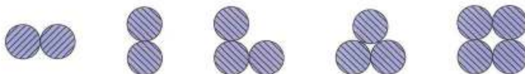
รูปที่ 2.23 ระยะการมัดเหล็กเสริมเป็นก้ำแบบ 2, 3 และ 4 เส้น
