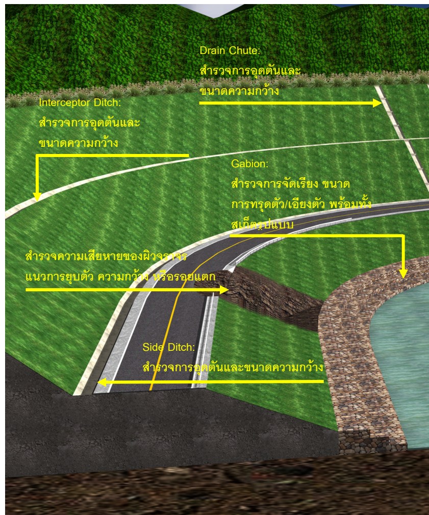
รูปที่ 3.1-2 จุดแนะนำในการตรวจสอบความเสียหายในสนามประเภท น้ำกัดเซาะบริเวณปลายเชิงลาดคันทาง
