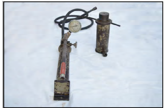
ชุดเพิ่มน้ำหนัก ประกอบด้วยแม่แรงไฮดรอลิก และมาตรวัดแรงกด (hydraulic jack with pressure gauge)
