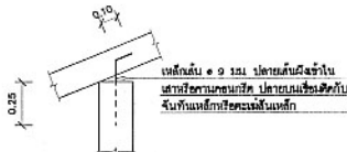
ขยาย ข การตั้งจันทันเหล็กและตะแ่งเส้นเหล็กบนเสาหรือคานคอนกรีต
