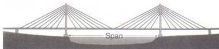
รูปที่ 14: ลักษณะรูปแบบของสะพานชิ่ง (Cable-stayed bridge)
