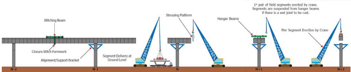
รูปที่ 51: การก่อสร้างแบบ Balanced Cantilever โดยใช้ Crane
