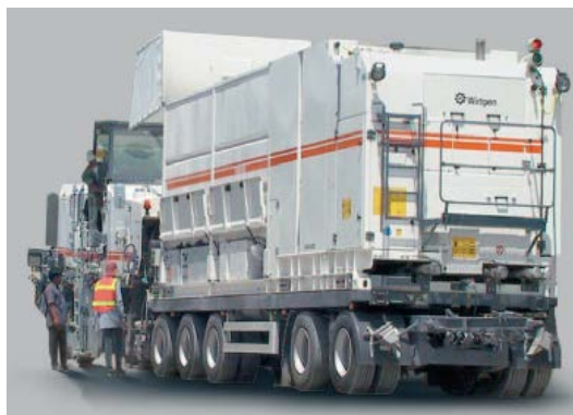
รูปที่ 18 เครื่องจักรสำหรับผสมน้ำปูนซีเมนต์ (Slurry Mixer) รุ่น WM 1000
