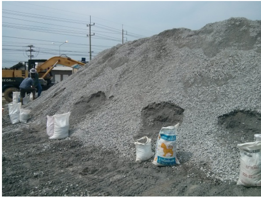
รูปที่ 90 การเก็บตัวอย่างวัสดุรวมมาทำเป็น Control Test
