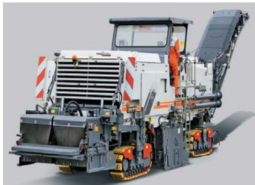
รูปที่ 17 เครื่องจักรชุดตัดผสม Wirtgen รุ่น Cold Recycler 2200 CR
