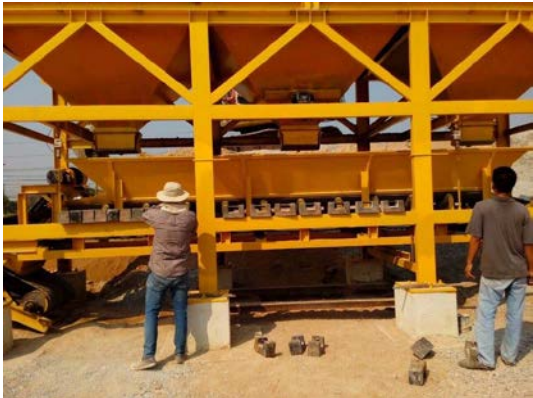
รูปที่ 44 การใส่ตุ้มน้ำหนักมาตรฐาน
