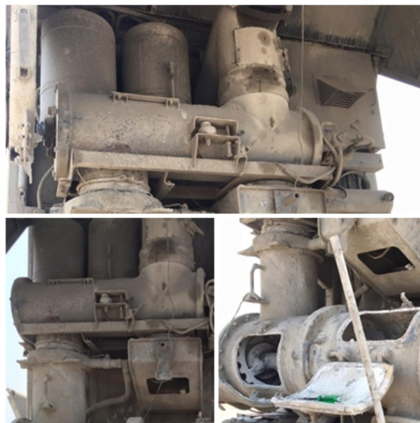
รูปที่ 37 ระบบจ่ายน้ำ และปูนซีเมนต์มายังห้องผสม
