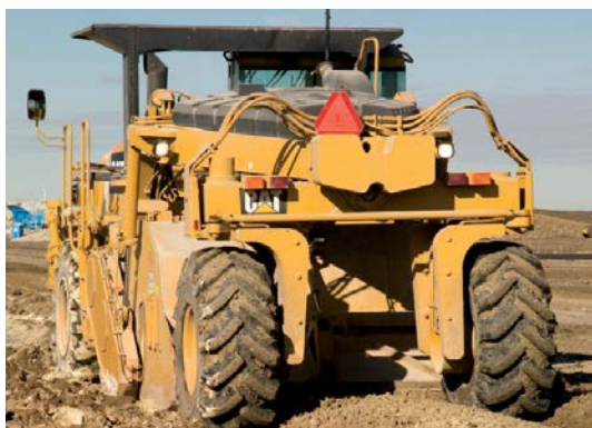
รูปที่ 20 เครื่องจักรสำหรับ Recycling CAT รุ่น RM500 ทำงานในลักษณะการปรับปรุงคุณภาพด้วยปูนซีเมนต์
