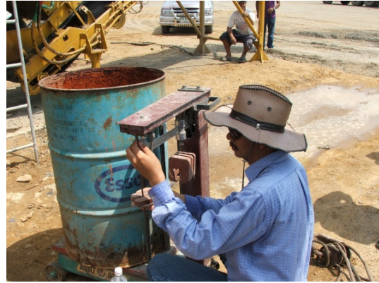
รูปที่ 62 นำภาชนะที่รองรับน้ำไปชั่งหาน้ำหนัก
