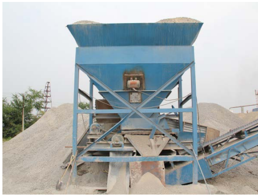
รูปที่ 8 ยุ้งหรือ Hopper รับวัสดุมวลรวม สามารถปรับช่องเปิดวัสดุให้มีอัตราการไหลตามที่ต้องการได้
