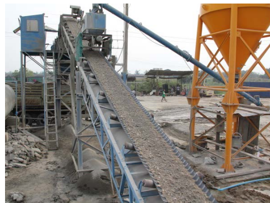
รูปที่ 9 ถังเก็บปูนซีเมนต์พร้อมท่อลำเลียงปูนซีเมนต์ที่มีสกรูด้านใน สามารถปรับรอบการหมุนได้
