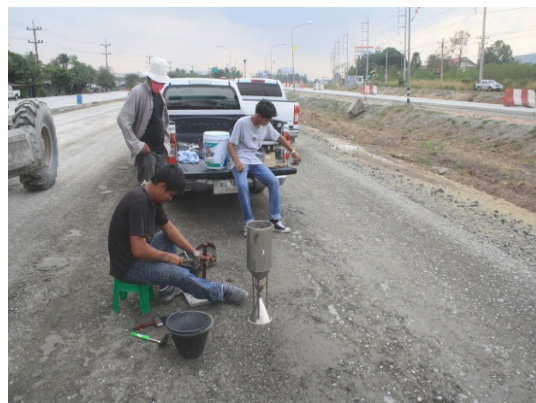
รูปที่ 91 การตรวจสอบความแน่นการบดทับ (Field Density Test)
