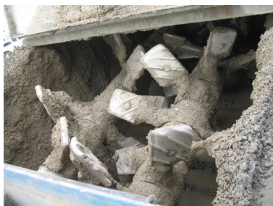
รูปที่ 12 ห้องผสม เป็นห้องที่วัสดุทุกอย่างมาผสมกันก่อนที่จะนำวัสดุผสมปูนซีเมนต์ไปใช้งาน ภายในห้องผสม จะประกอบไปด้วยใบกวนและหัวจ่ายน้ำ กวนเพื่อให้วัสดุผสมคลุกเคล้ากัน
