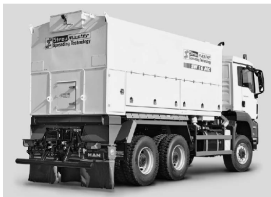
รูปที่ 19 เครื่องจักรสำหรับโรยปูนซีเมนต์ (Binding agent spreader MC Series)
