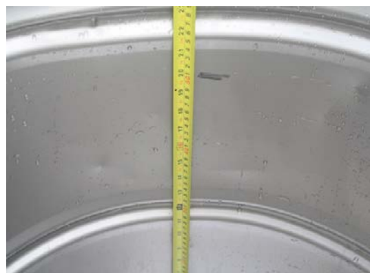
รูปที่ 68 การชั่งน้ำหนักภาชนะเปล่า และการหาปริมาตรของภาชนะรองรับน้ำ
