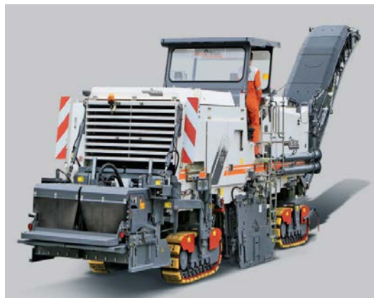
รูปที่ 16 ตัวอย่างเครื่องจักรชุดตัดผสมแบบเคลื่อนที่ (Wirtgen Thailand)
