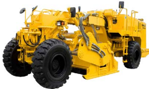
รูปที่ 23 เครื่องจักรสำหรับ Recycling Sakai รุ่น PM550, PM550-s
