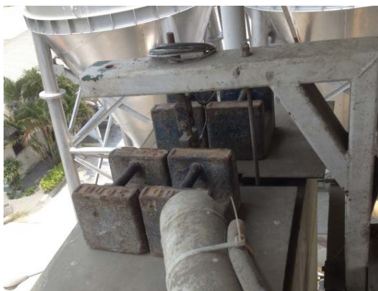
รูปที่ 50 การวางตุ้มน้ำหนักมาตรฐานเพื่อสอบเทียบเครื่องชั่งน้ำ
