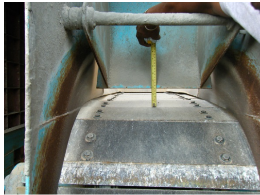
รูปที่ 8 ยุ้งหรือ Hopper รับวัสดุมวลรวม สามารถปรับช่องเปิดวัสดุให้มีอัตราการไหลตามที่ต้องการได้
