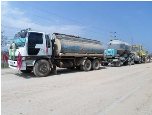
รูปที่ 25 ชุดเครื่องจักรประกอบด้วย รถบรรทุกน้ำใช้ลากจูง รถปูนซีเมนต์และเครื่องจักรชุดติดตั้งผสม
