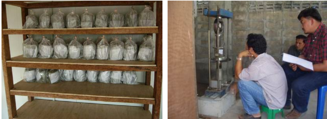
รูปที่ 88 การทดสอบกำลังรับแรงอัด (Unconfined Compressive Strength)
