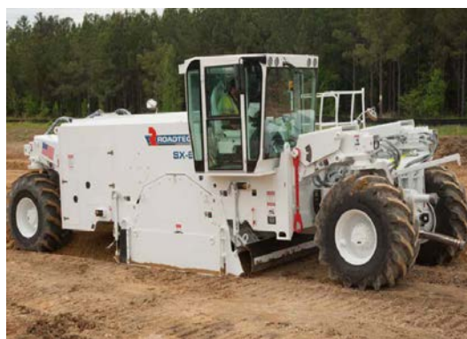
รูปที่ 24 เครื่องจักรสำหรับ Recycling Roadtec รุ่น SX-6
