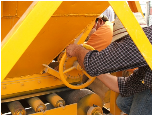
รูปที่ 51 บันทึกกระยะความสูงของการเปิดปากยั้ง
