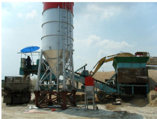
รูปที่ 9 ถังเก็บปูนซีเมนต์พร้อมท่อลำเลียงปูนซีเมนต์ที่มีสกรูด้านใน สามารถปรับรอบการหมุนได้
