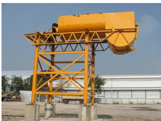
รูปที่ 12 ห้องผสม เป็นห้องที่วัสดุทุกอย่างมาผสมกันก่อนที่จะนำวัสดุผสมปูนซีเมนต์ไปใช้งาน ภายในห้องผสม จะประกอบไปด้วยใบกวนและหัวจ่ายน้ำ กวนเพื่อให้วัสดุผสมคลุกเคล้ากัน
