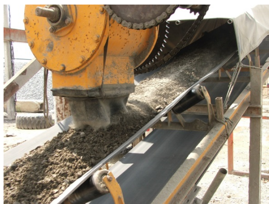
รูปที่ 11 สายพานลำเลียงวัสดุ จะนำวัสดุมวลรวมและปูนซีเมนต์ เข้าสู่ห้องผสม
