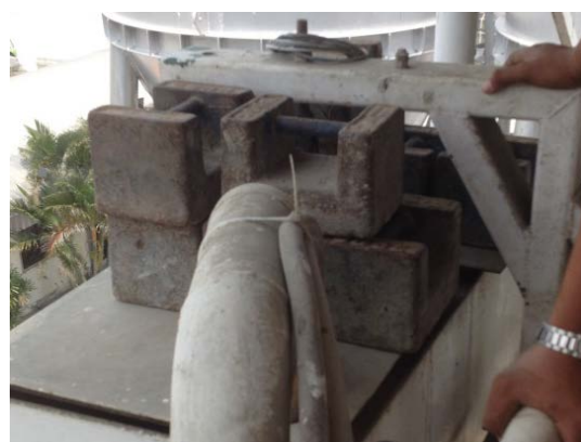
รูปที่ 50 การวางตุ้มน้ำหนักมาตรฐานเพื่อสอบเทียบเครื่องชั่งน้ำ
