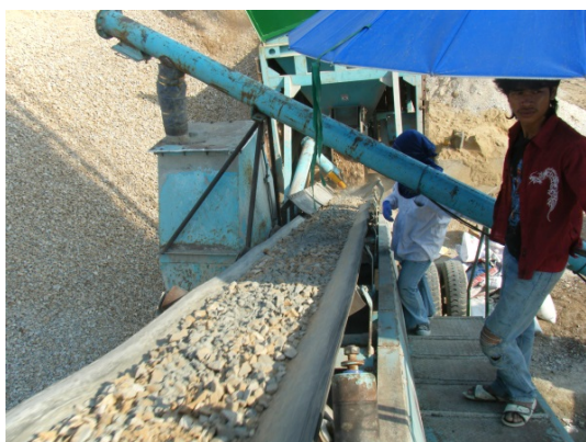
รูปที่ 11 สายพานลำเลียงวัสดุ จะนำวัสดุมวลรวมและปูนซีเมนต์ เข้าสู่ห้องผสม
