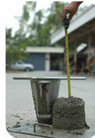
คอนกรีตที่ใช้ทรายสะอาด มีค่ายุบตัวสูงทำงานได้ง่าย
