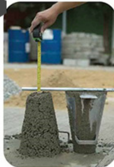
คอนกรีตที่ใช้ทรายสกปรก มีค่ายุบตัวต่ำทำงานลำบาก
