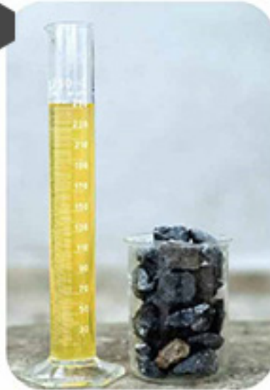
มวลรวมที่ขนาดละเอียด ต้องผสมน้ำมากเพื่อเติมเต็มช่องว่าง
