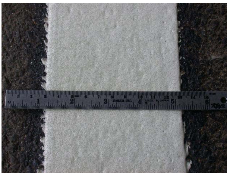
ภาพที่ 40 ภาพแสดงการวัดความกว้างของสีเทอร์พลาสติก
