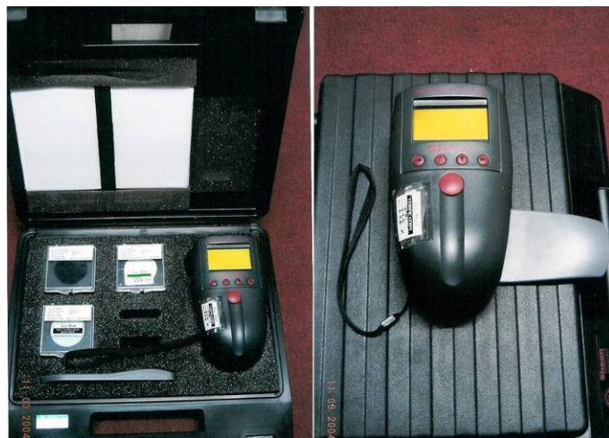
ภาพที่ 27 เครื่องวัดแฟลคเตอร์การสะท้อนแสง ในเวลากลางวัน (Reflectance)
