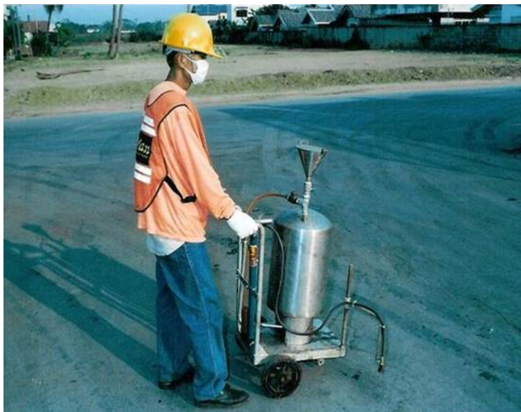
ภาพที่ 26 เครื่องพ่นวัสดุรองพื้น (Tack Coat หรือ Primer)
