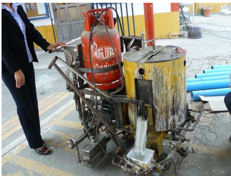
ภาพที่ 20 เครื่องตีเส้นจราจร สำหรับเครื่องแบบริดหรือปาดลาก
