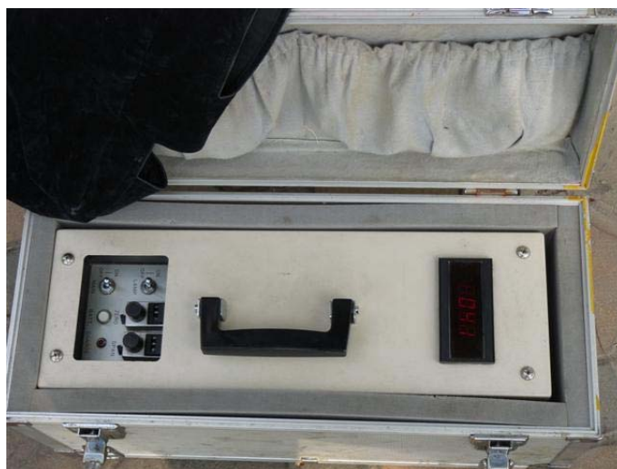
ภาพที่ 28 เครื่องวัดแฟลคเตอร์การสะท้อนแสง ในเวลากลางคืน (Retro reflectivity)
