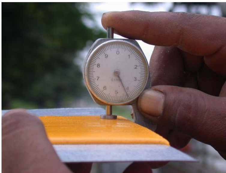
ภาพที่ 41 ภาพแสดงการวัดความหนา ตามที่กำหนดโดยใช้แผ่นโลหะผิวเรียบ
