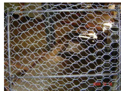
เหล็กโครงและลวดกรงไก่
