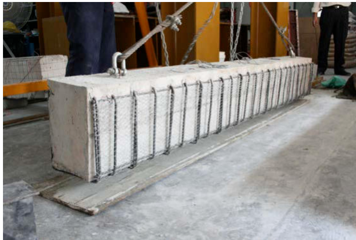
รูปที่ 6.15 ตัวอย่างการประยุกต์เฟอโรซีเมนต์เสริมกำลังต้านแรงเฉือนให้แก่คาน
