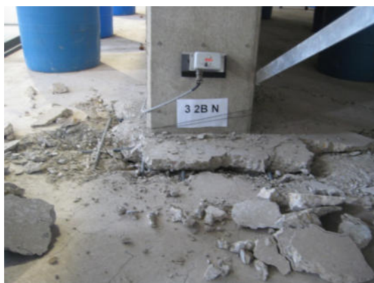
รูปที่ 5.1 (ก) การวิบัติแบบเฉือนทะลุ ในแผ่นพื้นคอนกรีต (ที่มา : http://www.scielo.br และ https://nees.org )
