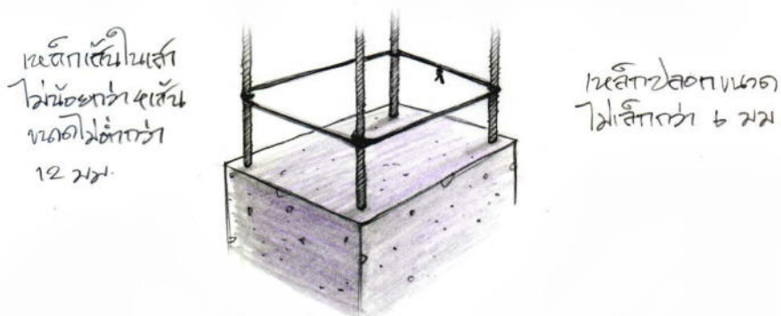
รูปที่ 8.1 การเสริมเหล็กในเสาคอนกรีตเสริมเหล็ก
