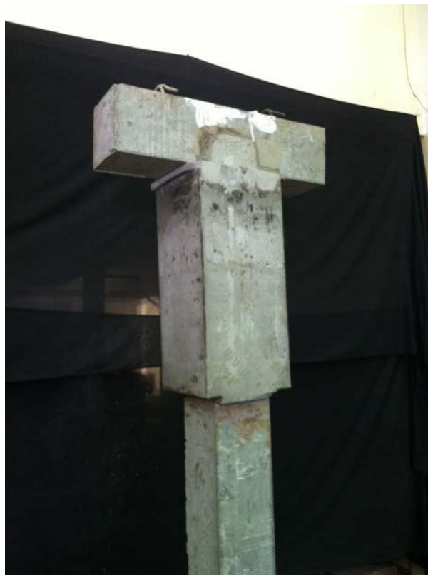
รูปที่ 7.6 (จ) เสาคือเทคอนกรีตหุ้มกรงเหล็กแล้ว
