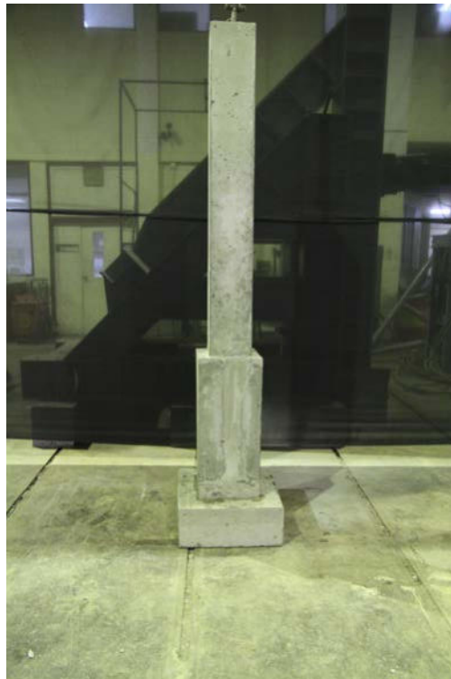
รูปที่ 7.7 (ค) เสาที่ทดสอบกรีดหุ้มกรงเหล็กแล้ว
