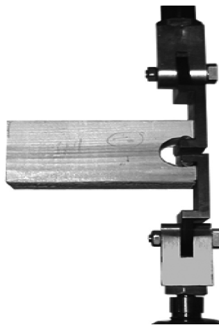
รูปที่ 2 เครื่องมือทดสอบความต้านทานการแตกของไม้ (ข้อ 4.2)
