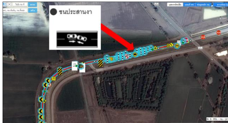
รูปที่ 4.3-3 รูปแบบการเกิดอุบัติเหตุ บริเวณ กม. 0+200
