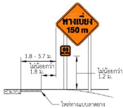
การติดตั้งป้ายบนทางหลวงชนบท (นอกเมือง) แบบมีป้ายแนะนำความเร็ว
