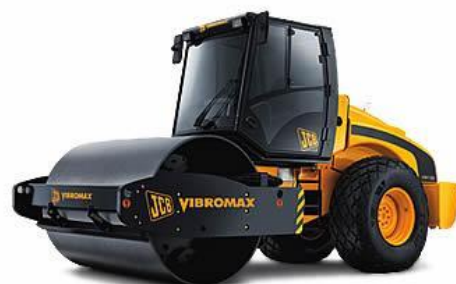
รถบดล้อเหล็กแบบสันสะเทือน
