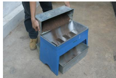
รูปที่ 3 ภาพการลดทอนตัวอย่างวัสดุด้วยเครื่องแบ่งตัวอย่าง
