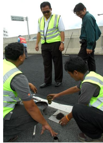
รูปที่ 5.5 ภาพการเก็บตัวอย่างและการทดลองหาความชื้นเหลว (Consistency) ของส่วนผสมพาราสเลอรี่ซีล
