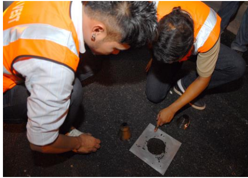
รูปที่ 5.6 ภาพเจ้าหน้าที่กำลังอ่านค่าการไหล (Flow) จากการทดลองหาค่าความชื้นเหลวของ ส่วนผสมพาราสเลอรี่ซีล
