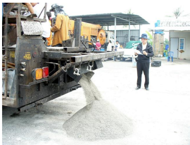
รูปที่ 7 ภาพเจ้าหน้าที่กำลังทำการสอบเทียบหินของเครื่องจักรงานพาราสลลอรี่ซีล
