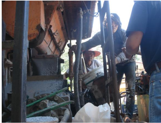
รูปที่ 3 ภาพเจ้าหน้าที่ใช้ภาชนะรองรับสารผสมเพิ่มจากเครื่องจ่ายขณะทำการสอบเทียบ
