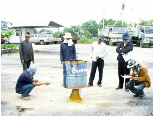
รูปที่ 5.16 ภาพเจ้าหน้าที่กำลังทำการชั่งวัสดุที่ไหล ออกมา บันทึกค่า แล้วนำค่าที่ได้ไป คำนวณหาอัตราการไหลต่อความดันต่อไป
