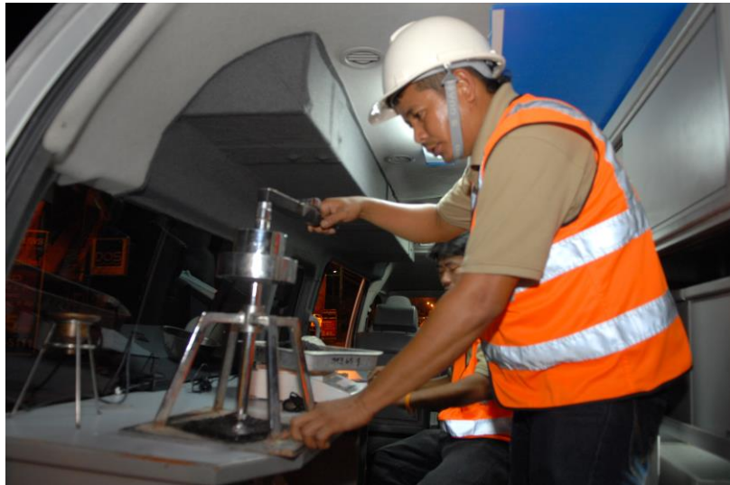
รูปที่ 5.9 ภาพการตรวจสอบระยะเวลาในการบ่ม(curing time) โดยเครื่อง Cohesion Tester
