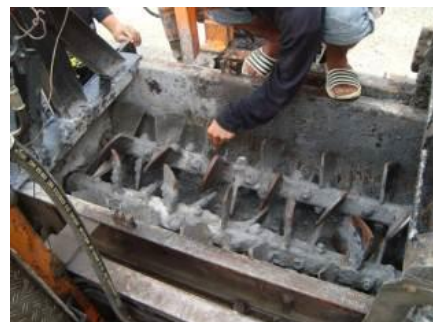
รูปที่ 4.10 การทำความสะอาดของส่วนผสมที่ติดค้างอยู่ภายในห้องผสม
