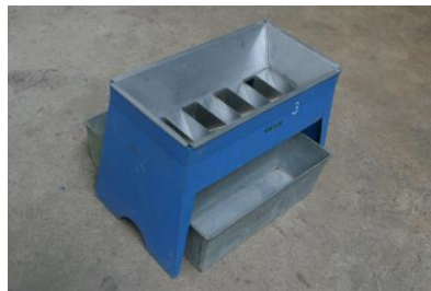
รูปที่ 3 ภาพการลดทอนตัวอย่างวัสดุด้วยเครื่องแบ่งตัวอย่าง
