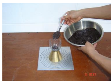
รูปที่ 5.5 ภาพการเก็บตัวอย่างและการทดลองหาความชื้นเหลว (Consistency) ของส่วนผสมพาราสเลอรี่ซีล
