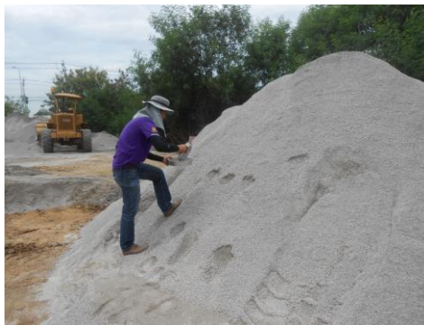
รูปที่ 5.2 ภาพการเก็บตัวอย่างมวลรวมจากกองวัสดุหน่วยงานเพื่อตรวจสอบคุณสมบัติ
