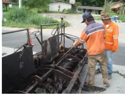
รูปที่ 4.11 ทำความสะอาดคราบของส่วนผสมที่ค้างอยู่ตามขอบยาง และแกนของใบกวบในเครื่องฉาบ (Spreader)
