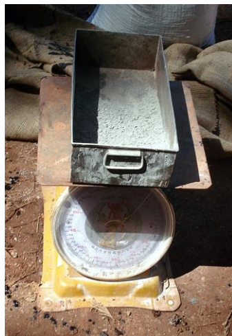
รูปที่ 9 ภาพการชั่งน้ำหนักปูนซีเมนต์ที่ถูกปล่อยออกมา ไป คำนวณหาปูนซีเมนต์ เพื่อปรับรอบเครื่องจ่ายปูนซีเมนต์
