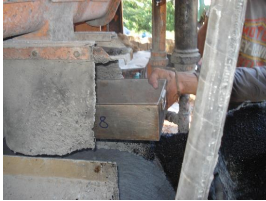
รูปที่ 8 เครื่องจักรงานพาราสเลอรี่ซีลขณะสอบเทียบปูนซีเมนต์
