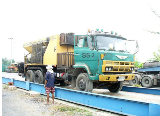
รูปที่ 2 ภาพขณะชั่งน้ำหนักเครื่องจักรงานพาราสลลอรี่ซีล หลังจากจ่ายแอสฟัลต์แล้ว
