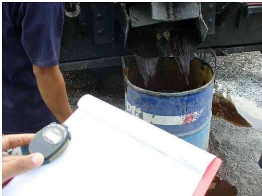
รูปที่ 5.15 ภาพการนำภาชนะมารองรับวัสดุ พร้อมจับ เวลาโดยกำหนดระยะเวลาให้เหมาะสมกับ อัตราการไหลของวัสดุ เพื่อให้ได้ปริมาณวัสดุ ที่เพียงพอ
