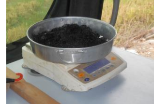
รูปที่ 5.7 ภาพเจ้าหน้าที่กำลังเก็บตัวอย่างส่วนผสม พาราสเลอริซีลเพื่อหาอัตราการฉาบ
