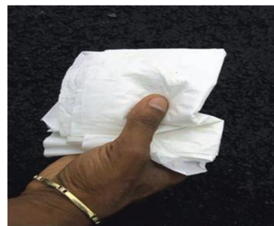
รูปที่ 5.8 ภาพการตรวจสอบระยะเวลาการแตกตัว (Initial Set time) ของส่วนผสมพาราสเลอริซีล
