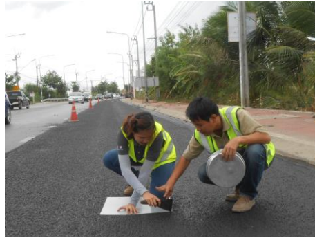
รูปที่ 5.7 ภาพเจ้าหน้าที่กำลังเก็บตัวอย่างส่วนผสม พาราสเลอริซีลเพื่อหาอัตราการฉาบ
