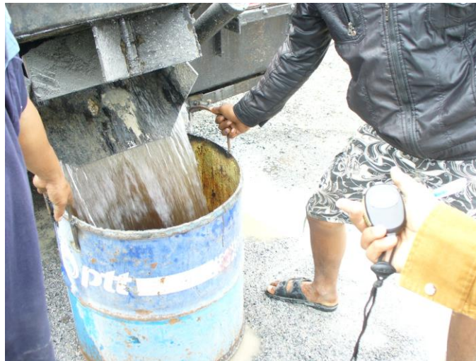
รูปที่ 5 เครื่องจักรงานพาราสเลอรี่ซีลขณะปรับเทียบน้ำ
