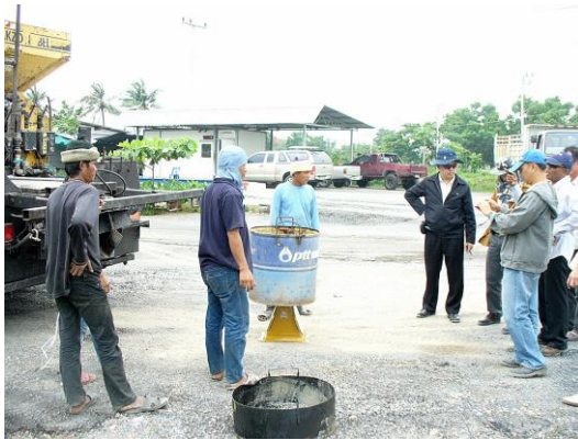
รูปที่ 5.13 ภาพเจ้าหน้าที่กำลังทำการชั่งน้ำหนักภาชนะ ที่จัดเตรียมไว้ซึ่งต้องเหมาะสมกับวัสดุ
