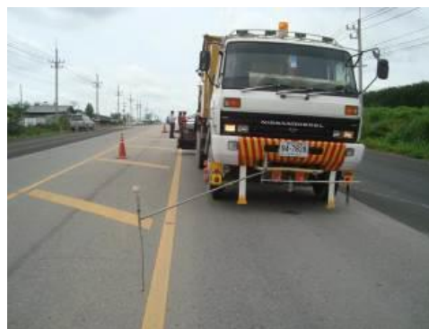
รูปที่ 4.15 ตัวเล็งแนวที่ติดตั้งไว้ด้านหน้ารถด้านขวา
