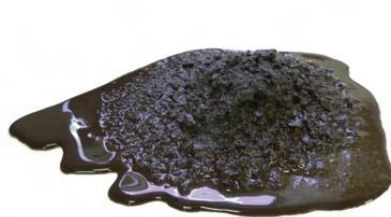
ส่วนผสมที่มีฝุ่นค่อนข้างน้อยและค่า Sand Equivalent สูง
