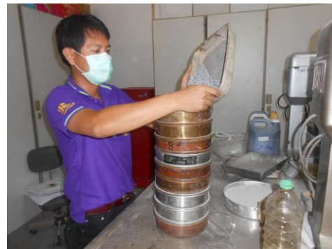
รูปที่ 5.2 ภาพการเก็บตัวอย่างมวลรวมจากกองวัสดุหน่วยงานเพื่อตรวจสอบคุณสมบัติ
