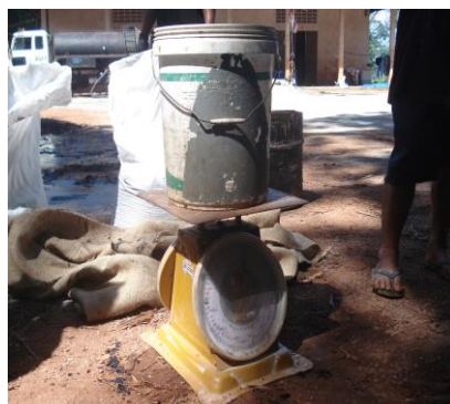
รูปที่ 4 ภาพการชั่งน้ำหนักสารผสมเพิ่มที่ปล่อยออกมาแต่ละรอบ
