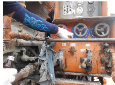
รูปที่ 4.2 ภาพการตรวจสอบและสอบเทียบมาตรวัด มวลรวม, แอสฟัลต์, ปูนซีเมนต์, สารผสมเพิ่ม และน้ำ
