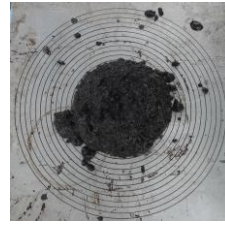
รูปที่ 5.6 ภาพเจ้าหน้าที่กำลังอ่านค่าการไหล (Flow) จากการทดลองหาค่าความชื้นเหลวของ ส่วนผสมพาราสเลอรี่ซีล
