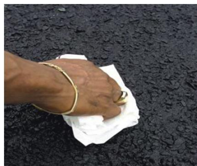
รูปที่ 5.8 ภาพการตรวจสอบระยะเวลาการแตกตัว (Initial Set time) ของส่วนผสมพาราสเลอริซีล
