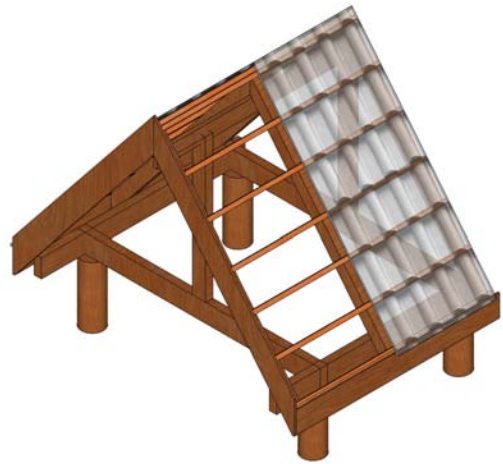
องค์ประกอบโครงสร้างพื้นฐานของหลังคาแบบจั่ว
