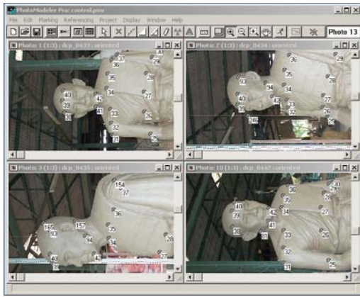
รูปภาพ 1-4 การรังวัดระยะใกล้ด้วยกล้องดิจิทัลเพื่อบันทึกภาพเหมือนเพื่อช่วยในการออกแบบก่อสร้าง
