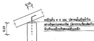
ขยาย ข การตั้งจันทันเหล็กและตะแคงเส้นเหล็กบนเสาหรือคานคอนกรีต
