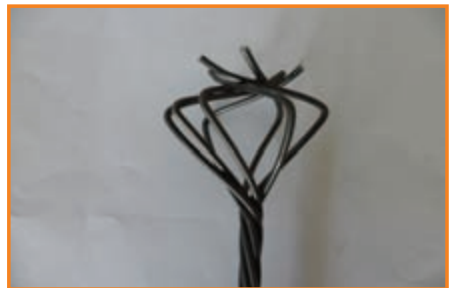
6. Spacer เป็นเหล็กแผ่นหนา 2 mm. ทำหน้าที่แยกลวดด้านปลาย Dead End ให้ห่างออกจากกัน
