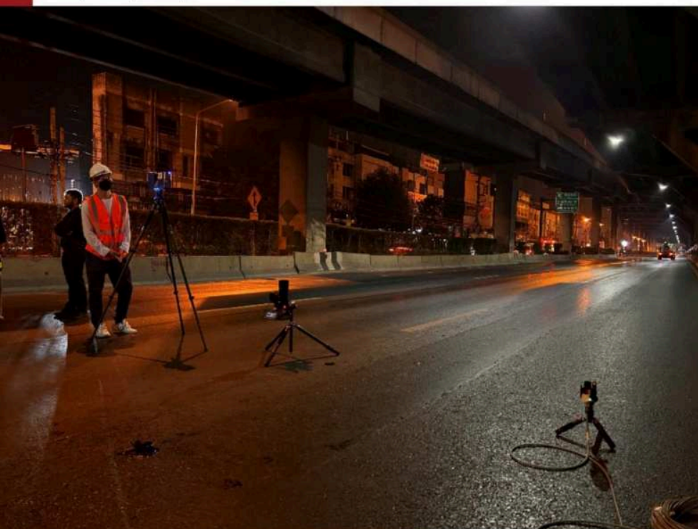
รูปที่ 3 เซนเซอร์วัดการเคลื่อนตัวด้วยเลเซอร์ กล้องดิจิทัล (เป้าม้วเร) และเครื่องสแกนสามมิติ
