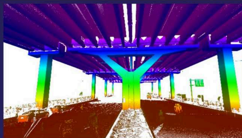
รูปที่ 6 ตัวอย่างผลกลุ่มจุดจากการสแกนสามมิติของสะพานระหว่างการทดสอบแบบสถิต (Step 0)
