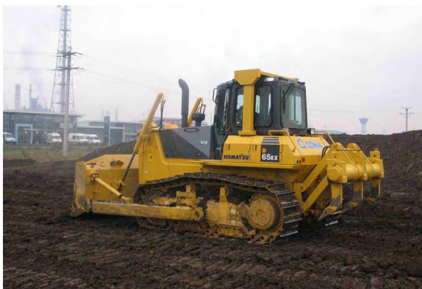
รถดันดินตะขาบติดเครื่องทำลาย (Ripper) ขนาด 270 แรงม้า สามารถทำงานได้ 560 ลบ.ม./วัน
