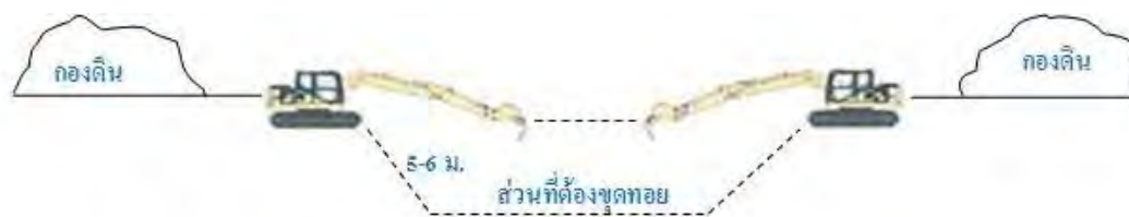
ภาพแสดงวิธีการขุดดินกรณีที่ขุดดินตามแนวคันคลอง
