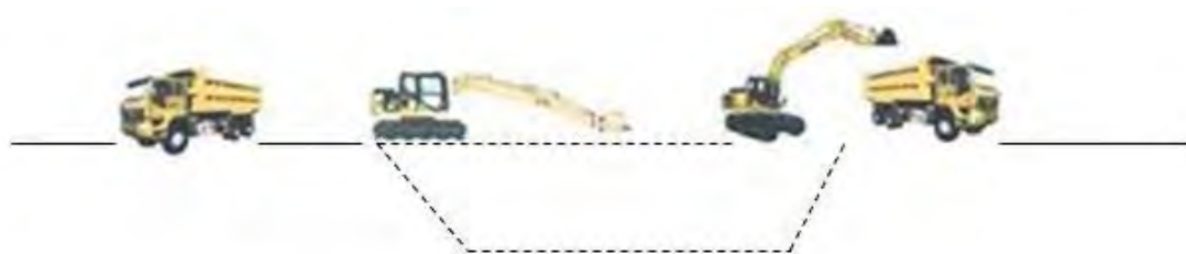
ภาพแสดงวิธีการขุดดินกรณีขนย้ายดินทิ้งนอกแนวคันคลอง
