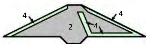
เขื่อนดินเนื้อเดียว (Homogeneous earth dam)
