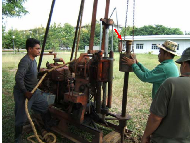
รูปที่ 6 : แสดงวิธีทดสอบ Standard Penetration Test (SPT)
