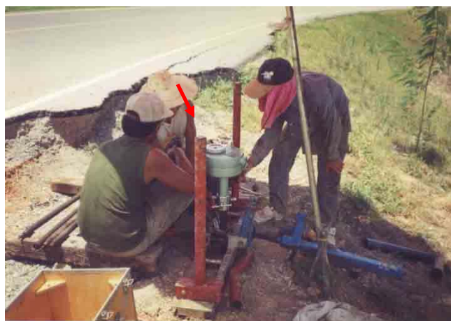
รูปที่ 8 : แสดงการทำ In situ Field Vane Shear Test ( Geonor Vane)
