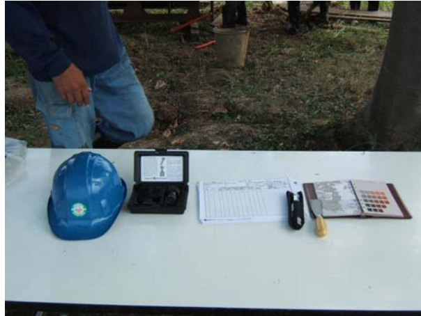
รูปที่ 15 : แสดงอุปกรณ์ประกอบในสนาม จากซ้ายไปขวาประกอบด้วย หมวกนิรภัย, เครื่องมือทดสอบ Pocket Shear Vane Device, Field Log Test, Pocket Penetrometer, Spatula และสมุดเทียบสีดิน
