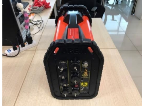
รูปที่ ซ-7 เครื่องวัดความต้านทานไฟฟ้ารุ่น Terrameter LS
