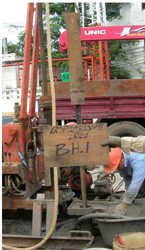
รูปที่ 7.2 และ 7.3 การติดตั้งอุปกรณ์ และทำเครื่องหมายเพื่อทำการทดสอบ Standard Penetration Test (SPT)
