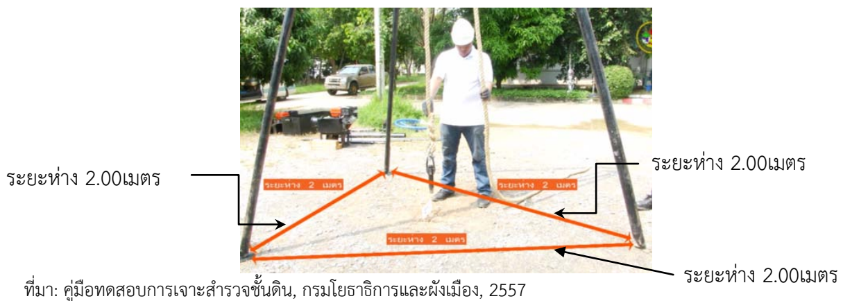
รูปที่ 6.5 การกำหนดตำแหน่งหลุมเจาะ และติดตั้งโครงสามขา
