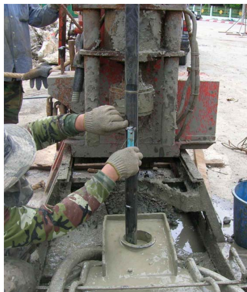
รูปที่ 7.2 และ 7.3 การติดตั้งอุปกรณ์ และทำเครื่องหมายเพื่อทำการทดสอบ Standard Penetration Test (SPT)
