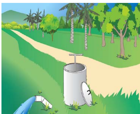
ท ระบายตะกอนทราย
