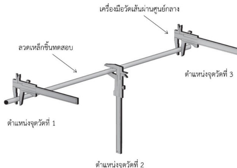
รูปที่ 1 แสดงการวัดแต่ละตำแหน่งที่ห่างกันให้วัดในลักษณะได้ฉากกัน
