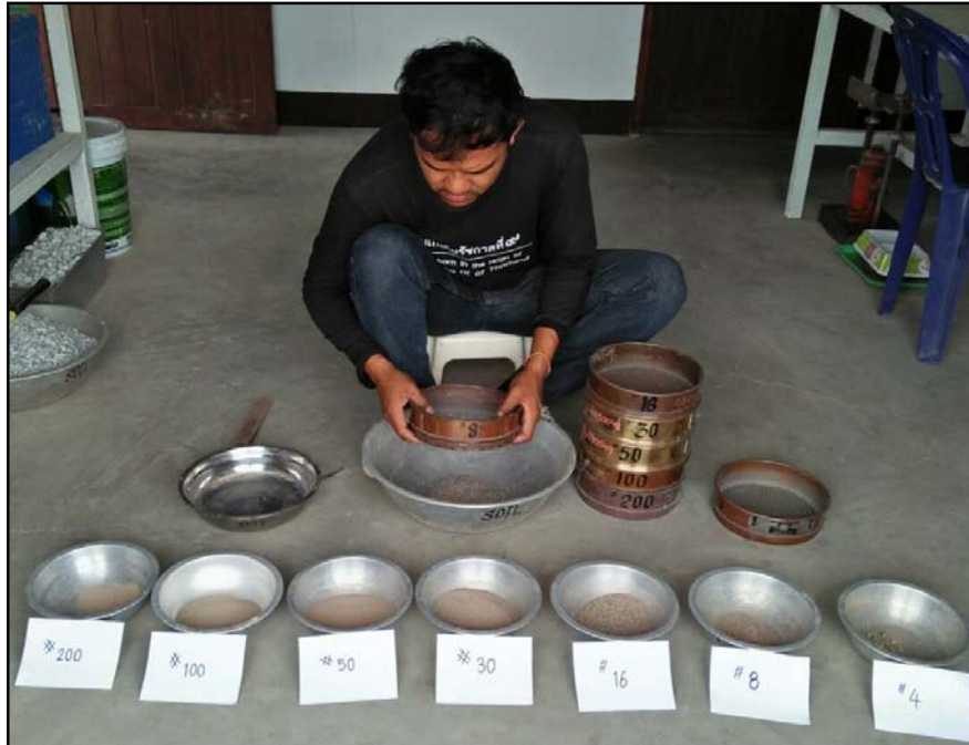
รูปที่ 29 วิธีการทดลองหาขนาดเม็ดของวัสดุ โดยผ่านตะแกรงแบบไม่ล้าง
