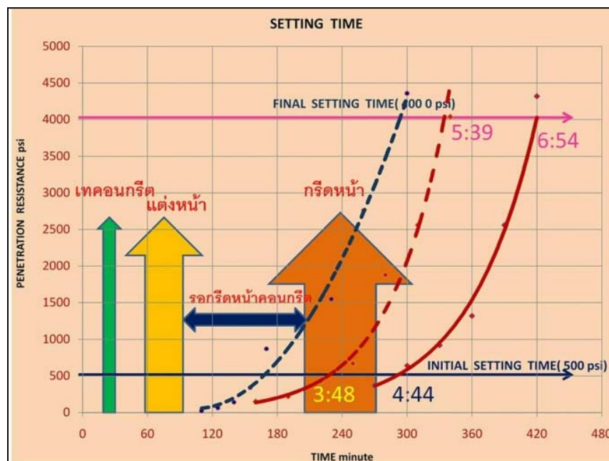
รูปที่ 139 ตัวอย่างการกำหนดช่วงเวลาที่เหมาะสมในการปฏิบัติงาน
