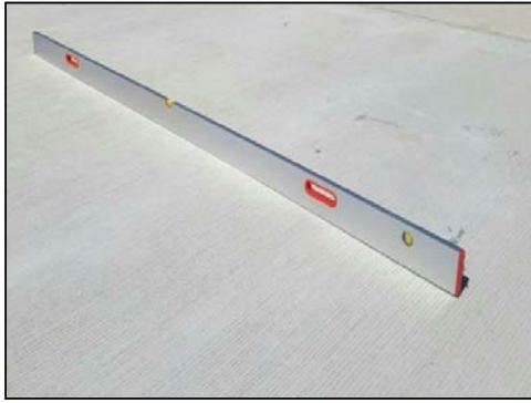
รูปที่ 149 การใช้ไม้บรรทัดตรงยาว 3 เมตรวัดสอบความเรียบรอยต่อ
