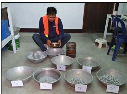
รูปที่ 39 การทดลองหาขนาดเม็ดของวัสดุ โดยผ่านตะแกรงแบบไม่ล้าง
