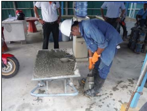
รูปที่ 113 การตรวจสอบค่าการยุบตัว (Slump Test)
