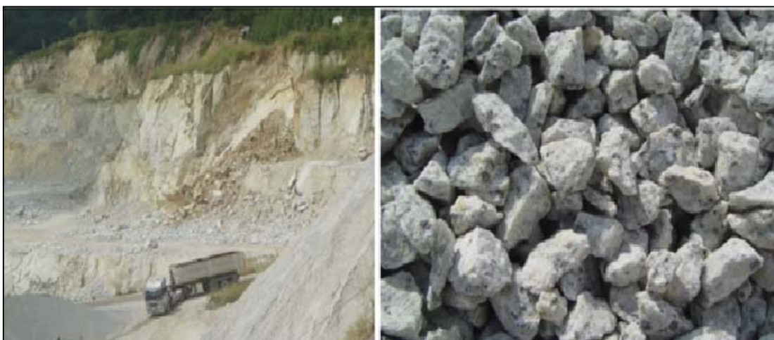
แหล่งหิน จังหวัดระยองและลักษณะหิน ซึ่งส่วนใหญ่เป็นหินแกรนิต ที่มา : http://www3.rdi.ku.ac.th/wp-content/uploads/2016/08/4.jpg รูปที่ 46 ตัวอย่างวัสดุหินผสมคอนกรีตตามแหล่งหิน
