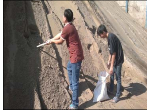
รูปที่ 103 การสุ่มเก็บตัวอย่างวัสดุจากโรงงานผสมคอนกรีต
