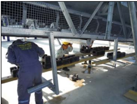
รูปที่ 107 การตรวจสอบเครื่องชั่งน้ำหนักวัสดุรวมรวม
