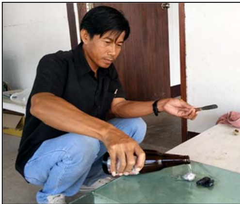
ทำการหยดกรดทดสอบหินผสมคอนกรีต
