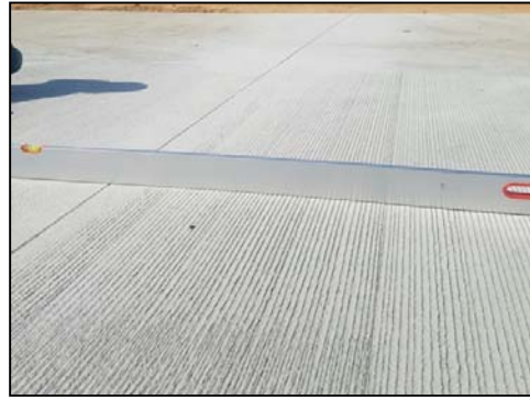
รูปที่ 149 การใช้ไม้บรรทัดตรงยาว 3 เมตรวัดสอบความเรียบรอยต่อ
