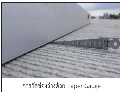
รูปที่ 150 การตรวจสอบความเรียบของผิวคอนกรีตระหว่างการก่อสร้าง
