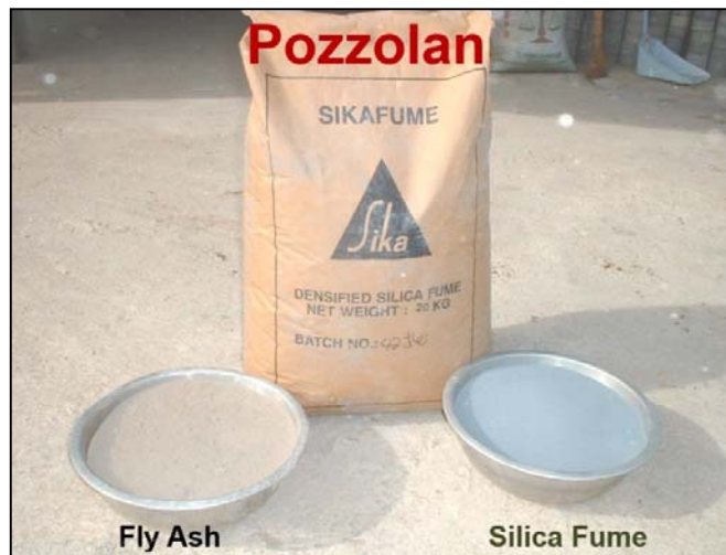
รูปที่ 65 ตัวอย่างสารผสมเพิ่มชนิดผง วัสดุประเภทปอซโซลาน
