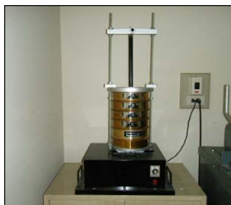
รูปที่ 39 การทดลองหาขนาดเม็ดของวัสดุ โดยผ่านตะแกรงแบบไม่ล้าง
