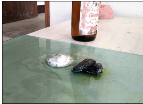
หินที่น้ำกรดไม่ทำปฏิกิริยา จะไม่เกิดฟองฟู สันนิษฐานว่าหินนั้น มีคุณสมบัติที่ใช้ไม่ได้
