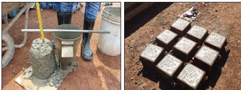
รูปที่ 140 การทดสอบค่ายุบตัวของคอนกรีตและการเก็บตัวอย่างคอนกรีตบริเวณพื้นที่ก่อสร้าง
