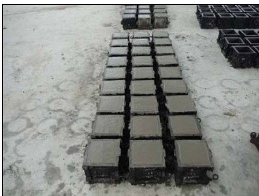
รูปที่ 101 การทดลองผสมคอนกรีตตามรายการคำนวณ (Trial Mixed)
