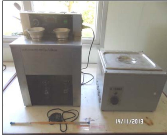
รูปที่ 87 ชุดทดสอบ ความหนืดด้วยวิธีเซย์โบลต์
