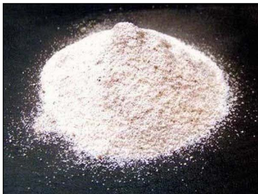
รูปที่ 63 ตัวอย่างตะกรันเตาถลุง หรือตะกรันเหล็ก เป็นวัสดุประเภทวัสดุเชื่อมประสาน
