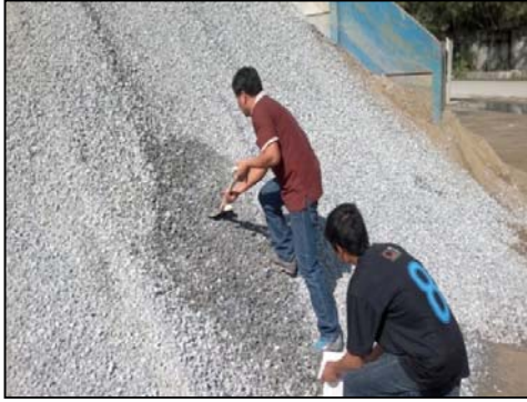
รูปที่ 103 การสุ่มเก็บตัวอย่างวัสดุจากโรงงานผสมคอนกรีต
