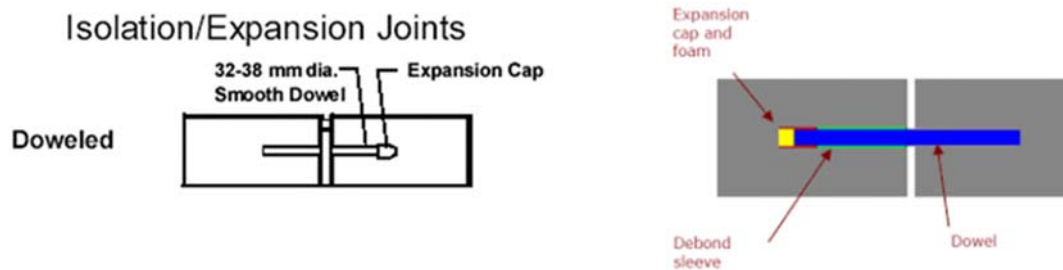
รูปที่ 81 ตัวอย่างรายละเอียดแบบขยายการใส่ปลอกเหล็กเดี่ยว ที่ระบุในแบบก่อสร้าง
