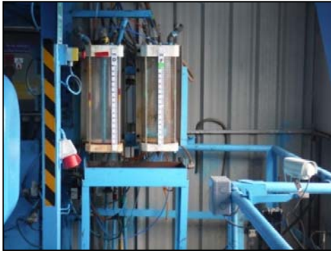
รูปที่ 110 การตรวจสอบมาตรฐานวัดปริมาณสารผสมเพิ่ม (Admixture)
