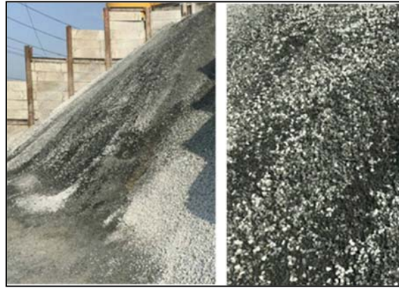
สีของหินผสมคอนกรีตที่ไม่เหมาะสม
