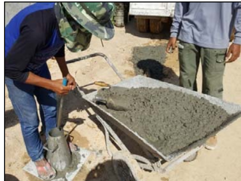
รูปที่ 113 การตรวจสอบค่าการยุบตัว (Slump Test)
