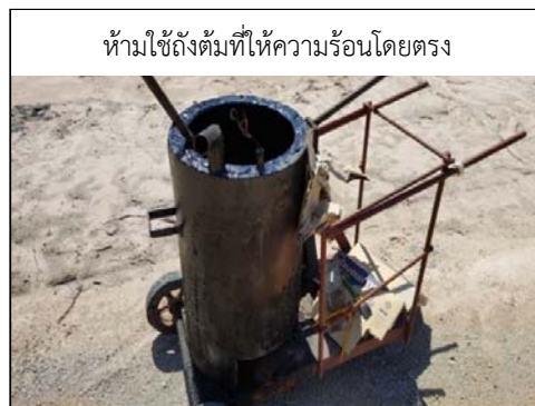
รูปที่ 160 ถังต้มที่ให้ความร้อนวัสดุรอยต่อ
