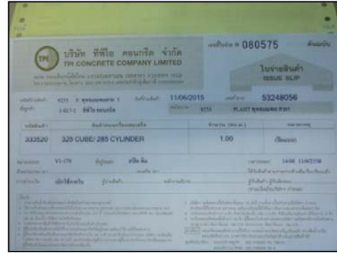
รูปที่ 112 ตัวอย่างรายละเอียดส่วนผสมคอนกรีตและใบนำส่งคอนกรีต
