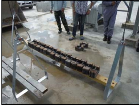
รูปที่ 108 การตรวจสอบเครื่องชั่งน้ำหนักปูนซีเมนต์
