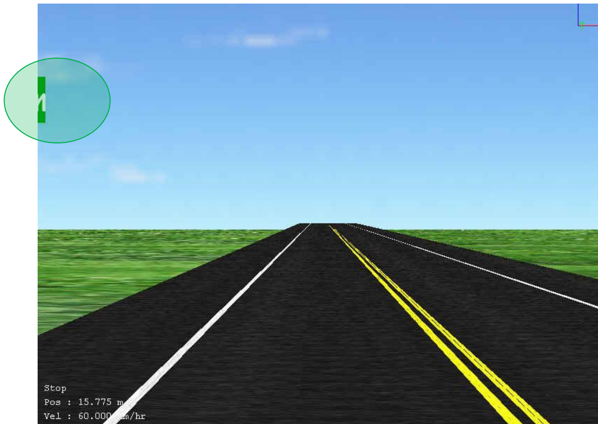
รูปที่ 1.1 แสดงระยะสิ้นสุดของการมองเห็นป้ายข้างทาง On Ground ขณะยานพาหนะแล่นด้วยความเร็ว 60 กิโลเมตรต่อชั่วโมง บนทางหลวงชนบท 2 ช่องจราจร
