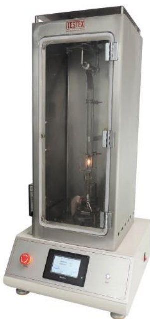
รูปที่ 3.28 เครื่องทดสอบการวัดการเผาไหม้และการลามไฟ ของวัสดุสิ่งทอ NFPA 701 Method 2 [25]
