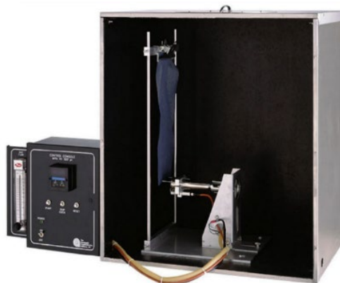
รูปที่ 3.22 เครื่องทดสอบการวัดการเผาไหม้และการลามไฟ ของวัสดุสิ่งทอ NFPA 701 Method 1 [24]
