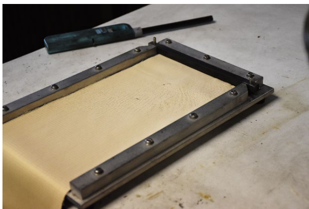
รูปที่ 3.25 การติดตั้งชิ้นตัวอย่างกับ pin bar
