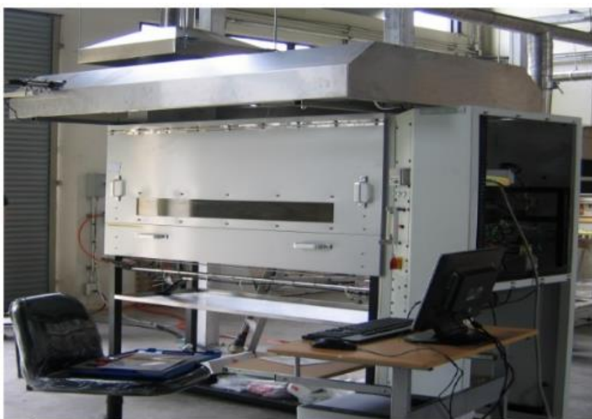
รูปที่ 3.11 เครื่องทดสอบบ่งชี้ความร้อนวิกฤติสำหรับวัสดุตกแต่งผิวภายใน [22]
