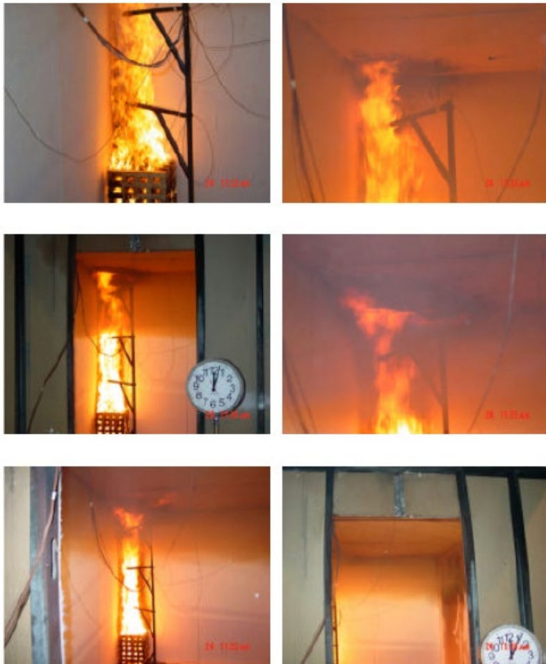
รูปที่ 3.10 การทดสอบการเผาไหม้ของวัสดุตกแต่งผิวภายในห้องทดสอบ [19]
