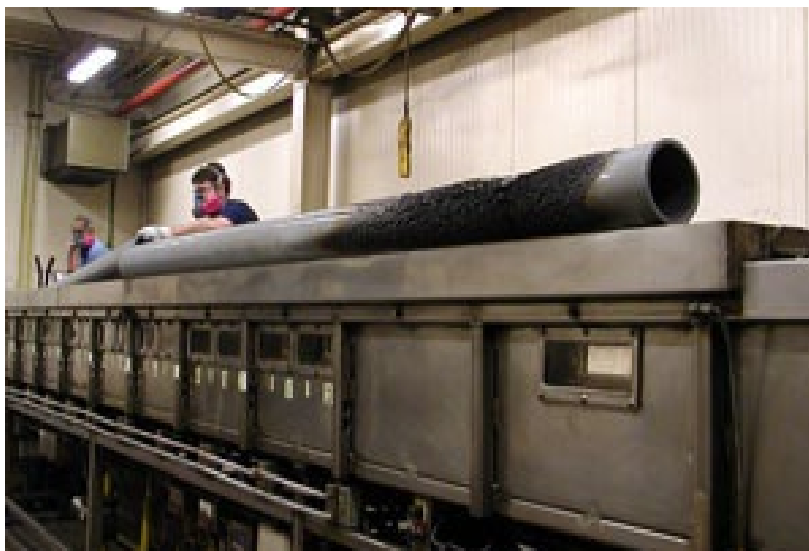
รูปที่ 3.4 เครื่องทดสอบการลามไฟและการกระจายควัน (มยผ. 8206-52 [16])
