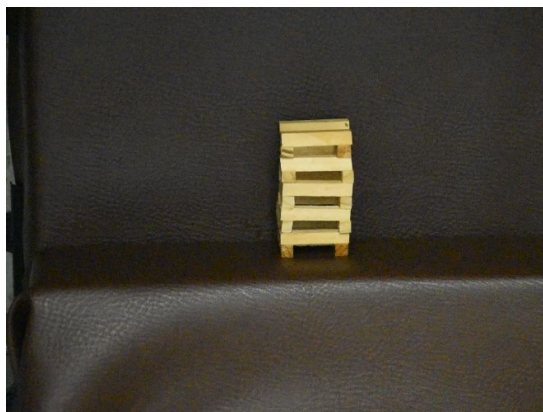
รูปที่ 3.43 ตัวอย่างการวางแหล่งกำเนิดไฟ BS 5852 Source 5
